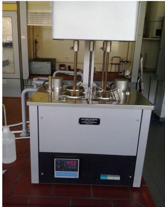
Slika 2. Uređaj za pripremu sladovine po kongresnoj metodi Glasbläserei (Izvor: Rebeka Fric).
