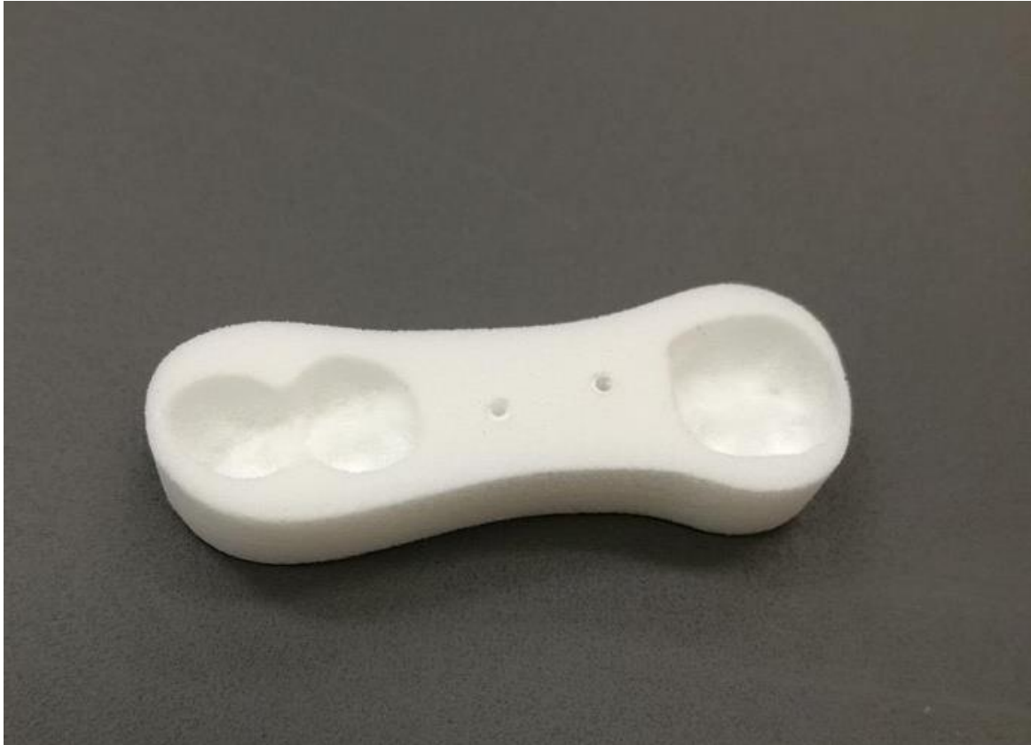
Slika 51. Izrađena vodilica 3D printanjem od materijala nylon.
