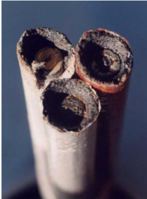
Slika 21. Elektrode Navy 1 i Navy 2 nakon završetka zavarivanja [20]
