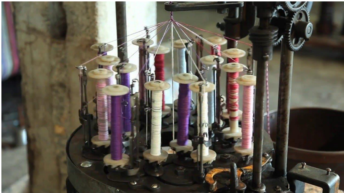
SLIKA 9. „MAYPOLE“ stroj za pletenje [9]
