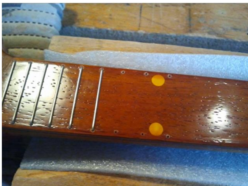
Slika 25. Izrada kota (pragova) čeličnom žicom [14]
