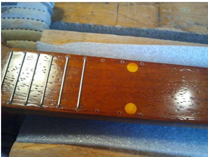
Slika 25. Izrada kota (pragova) čeličnom žicom [14]
