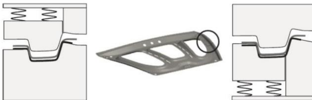
Slika 3.71 Moguće osnovne izvedbe alata za dodatno oblikovanje
