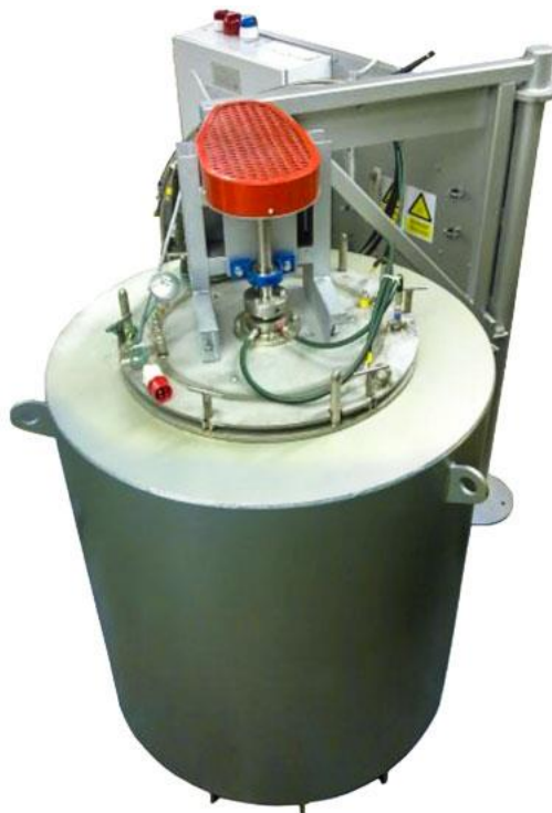
Slika 5.1.. Tipična peć za plinsko nitiranje [9]
