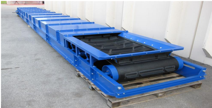
Slika 23. Trakasti transporter s pokrovom
