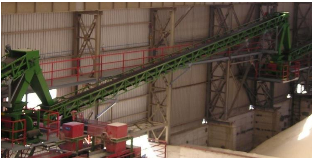
Slika 45. Transportna linija sipkog materijala (pijeska) u tvrtci Vetropack straža d.d. – Hum na Sutli
