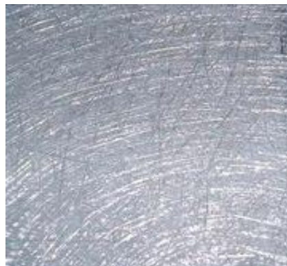
Slika 12. Stakleni mat 400g/m 2 [7]
