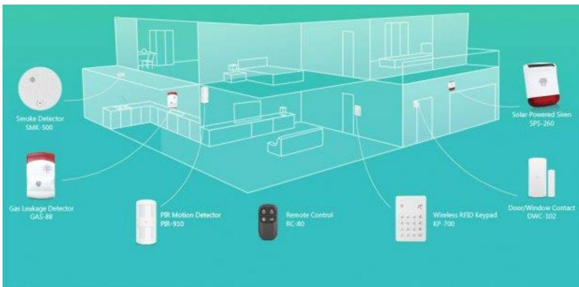
Slika 8. Predodžba bežičnog alarmnog sustava
