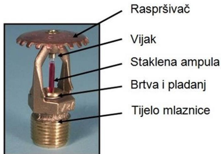
Slika 37. Osnovni dijelovi sprinkler mlaznice [24]
