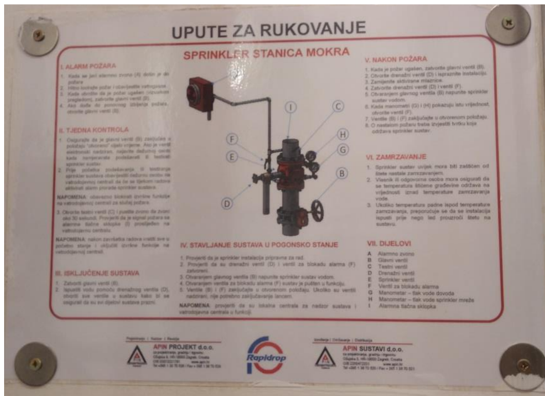
Slika 40. Uputa za rukovanje sprinkler sustavom – mokri [10]
