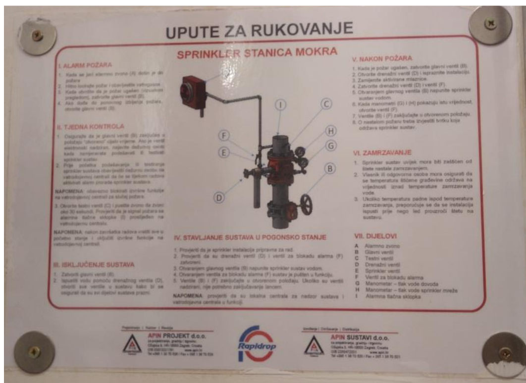
Slika 40. Uputa za rukovanje sprinkler sustavom – mokri [10]
