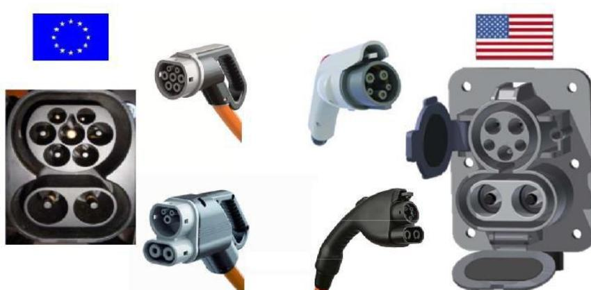
Slika 40. Combo 1 (desno) i Combo 2 (lijevo) konektor
