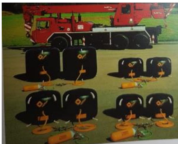
Slika 13. Niskotlačni zračni jastuci [1]
