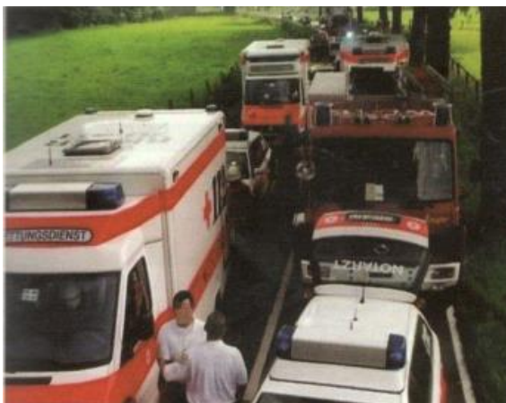
Slika 1. Nepravilan raspored interventnih vozila [1]
