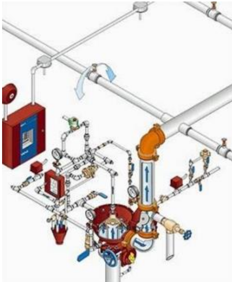
Sl. 5. Stabilni sustav sa predalarmom [2]
