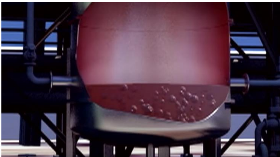
Slika 15. Reakcija Metil izocijanat-a i vode
