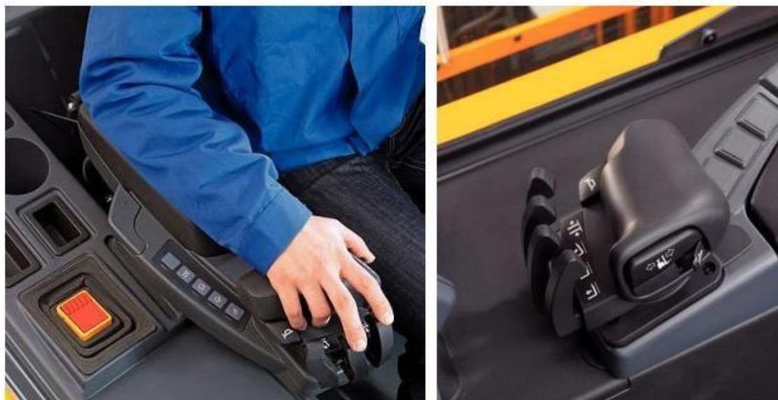
Sl. 34. Izvedba elektroničkog upravljanja [8]
