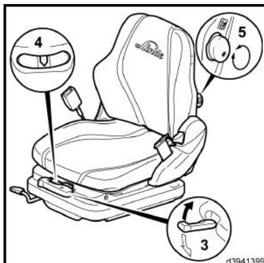
Sl. 30. Mogućnosti namještanja sjedala Linde H25D [8]
