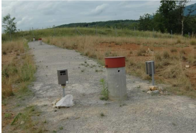
Slika br. 6 Kontrolna pješčana traka i fotozamke na zelenom mostu Ivačeno brdo
