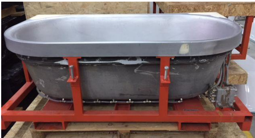
Slika 11: Primjer aluminijskog kalupa
