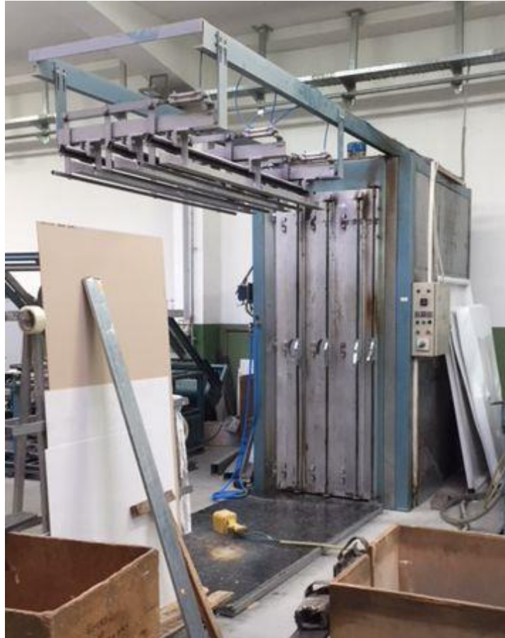
Slika 12: Vertikalna peć s 3 staze za zagrijavanje ploča
