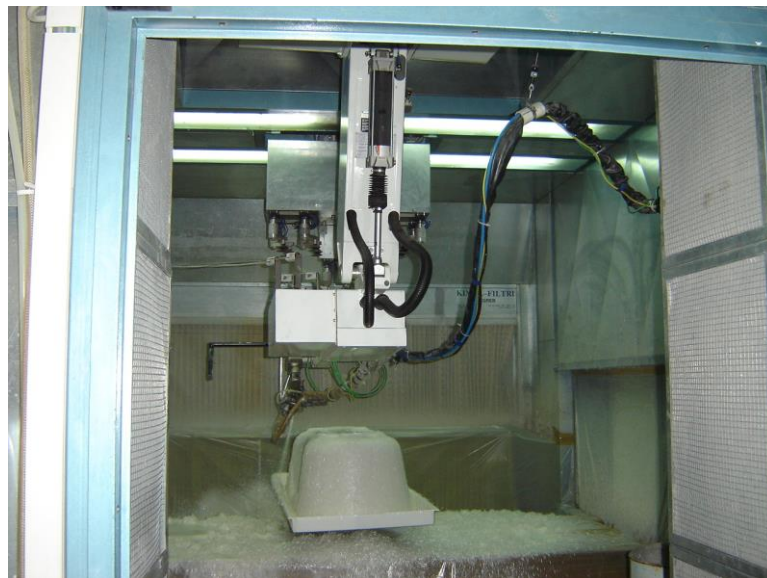
Slika 16: Kabina za automatsko nanošenje smjese za ojačanje
