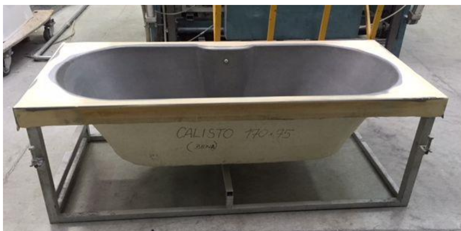
Slika 10: Primjer poliesterskog kalupa
