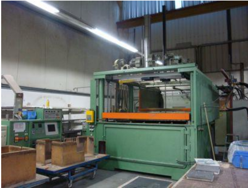
Slika 15: Automatski stroj za termo formiranje
