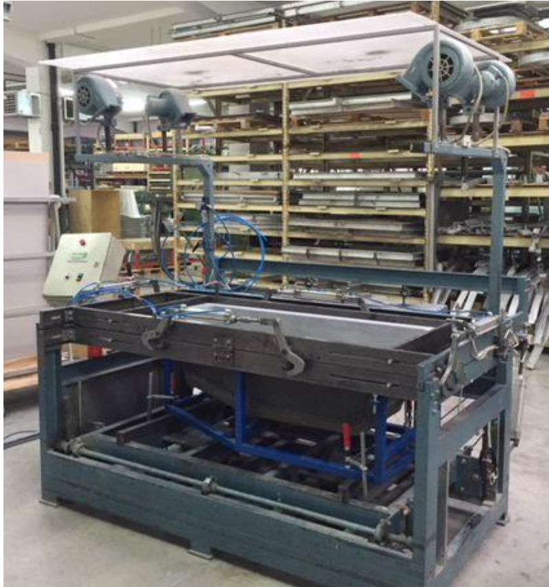
Slika 14: Polu automatski stroj za termo formiranje
