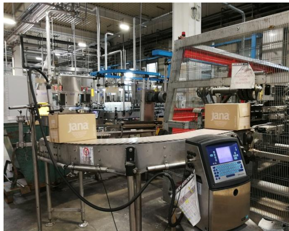
Slika 13. Transportna traka od upakivača prema paletizatoru
