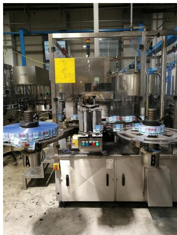
Slika 7. Etiketirka – prikaz spojenog koluta
