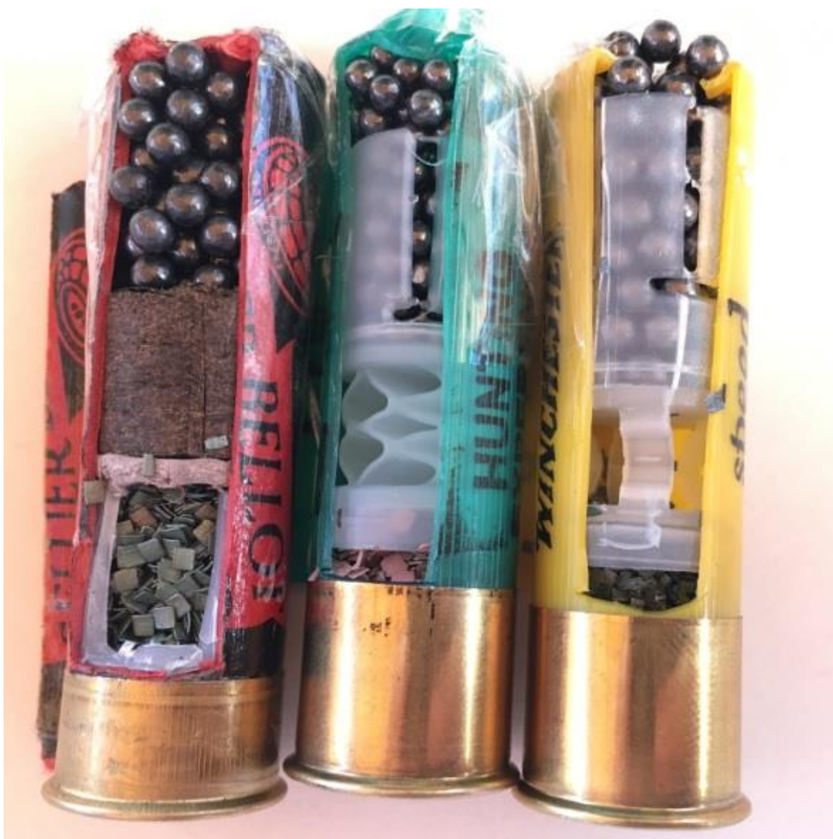
Slika 1. Prikaz presjeka sva tri metka s kojima je izvršen test
