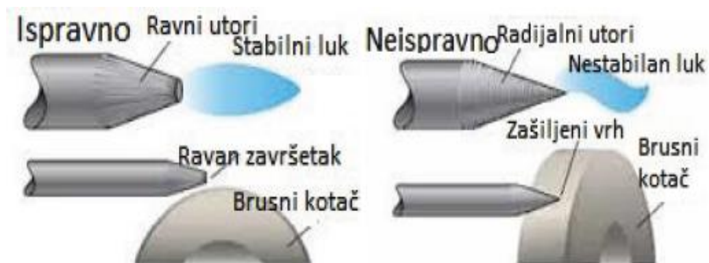
Slika 7. Pravilno i nepravilno brušenje elektrode [5]
