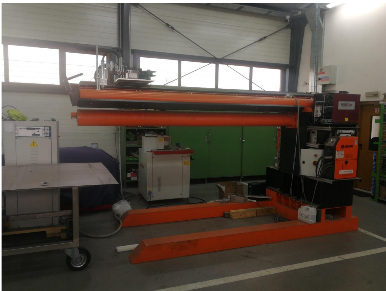
Slika 24. Automatizirani sustav za automatsko uzdužno zavarivanje u pogonu tvrtke Tomo Varga d.o.o.
