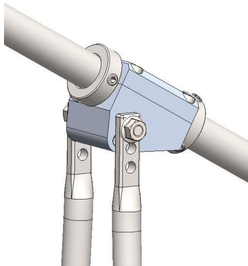
Slika 24 Gornje kućište volana na nosačima
