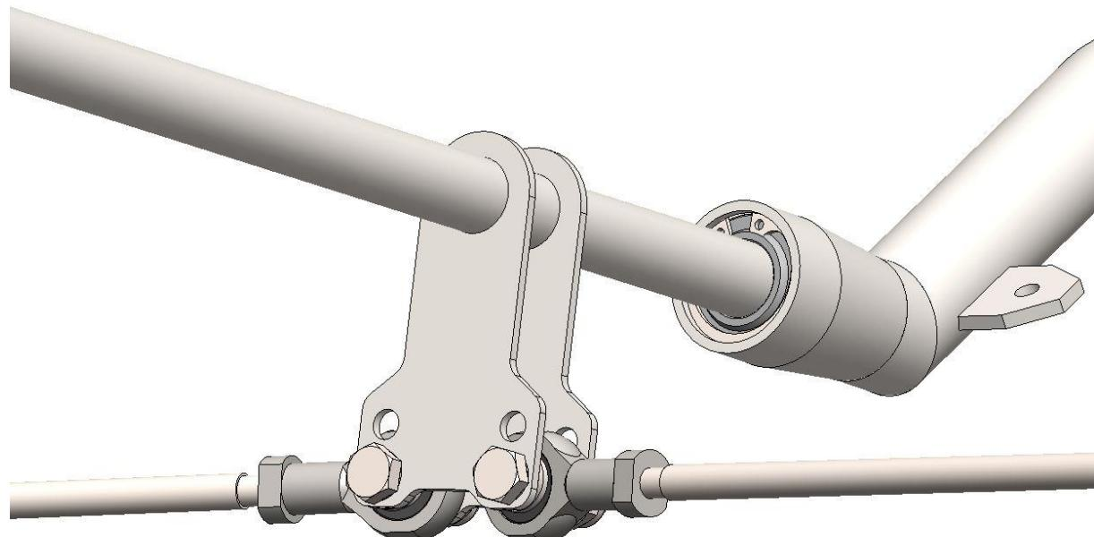
Slika 27 Sklop ležaja i pločica skretanja
