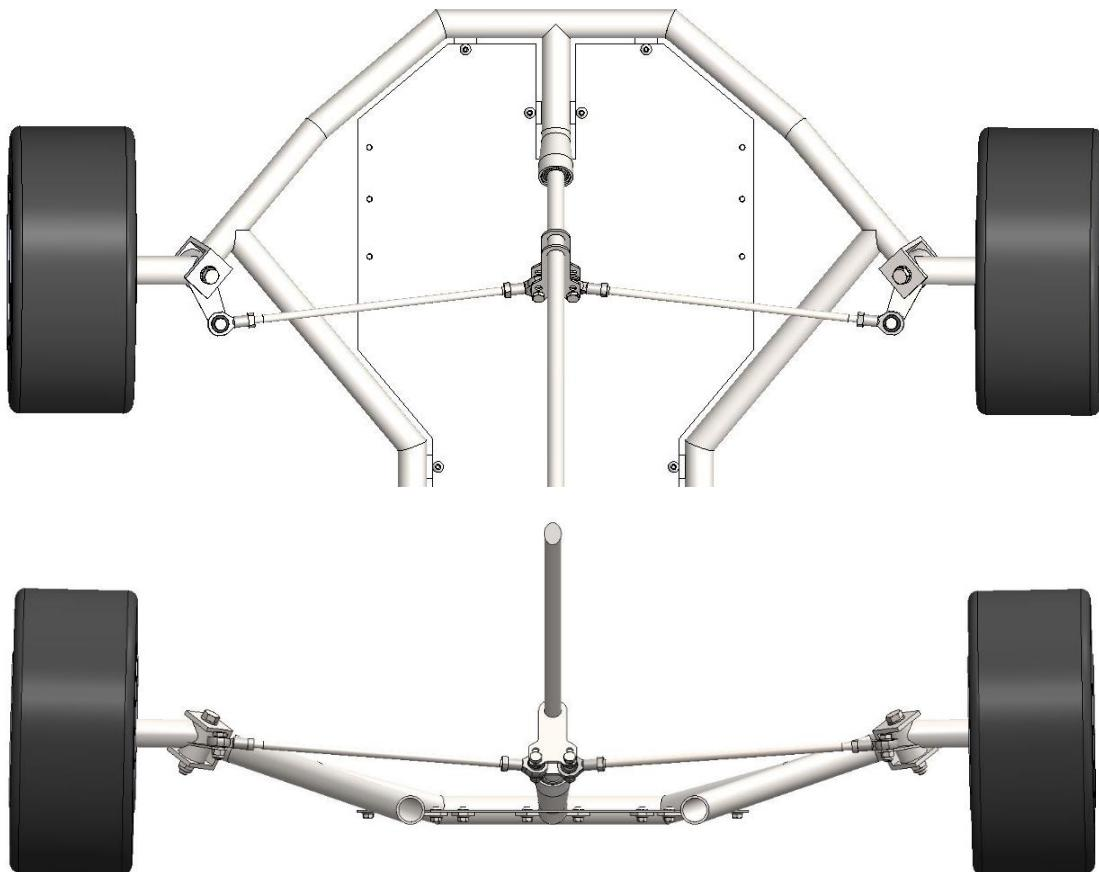
Slika 34 Sklop svih dijelova potrebnih za skretanje
