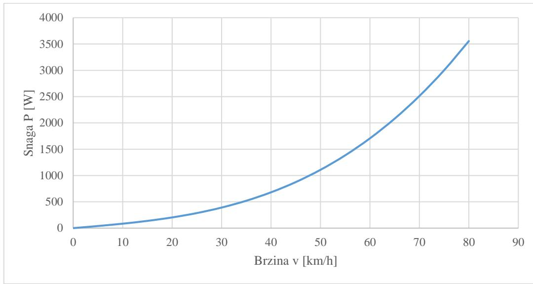
Slika 11 Graf snage i brzine, prema jednadžbi (1)
