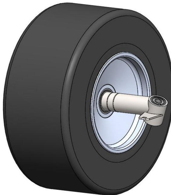
Slika 31 Sklop kotača s prednjom osovinom
