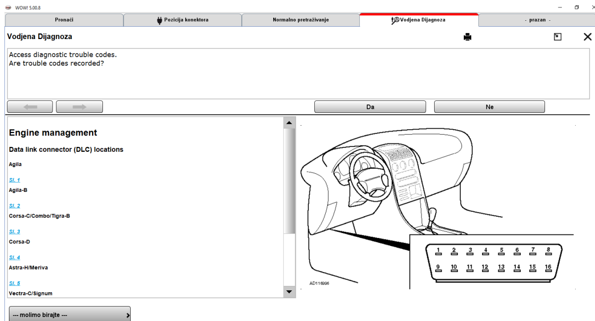
Slika 27. Vođena dijagnostika – upit o statusu koda greške
