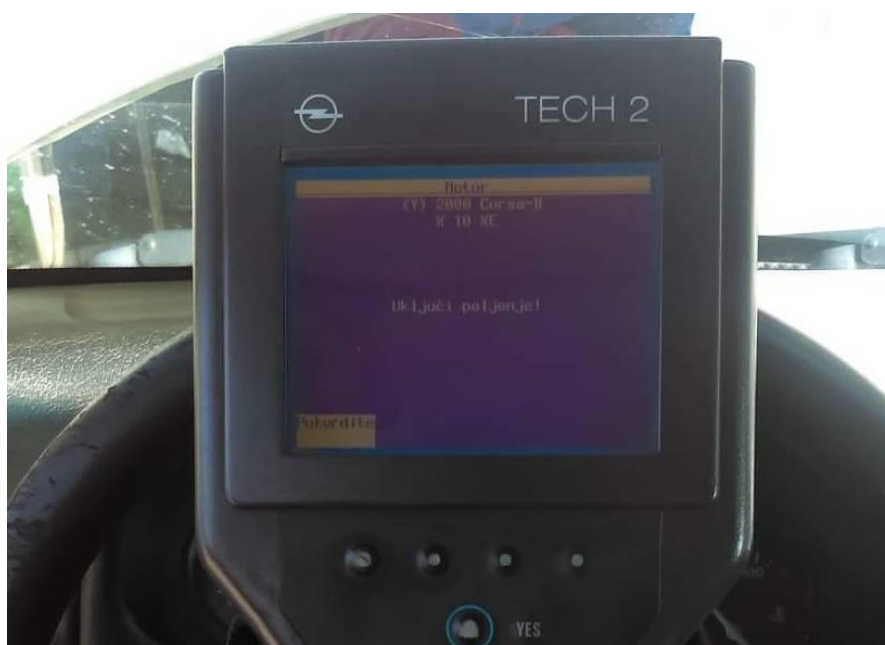
Slika 36. Uputa dijagnostike za paljenje kontakta na vozilu
