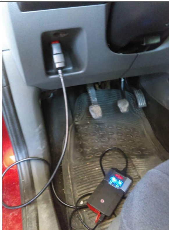
Slika 19. Primjer uspješnog spajanja dijagnostike
