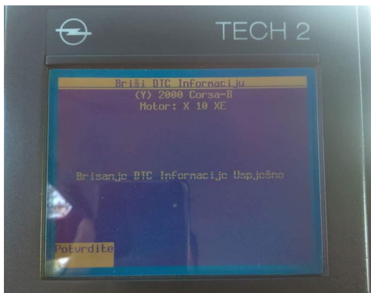
Slika 39. Brisanje kodova greške na vozilu
