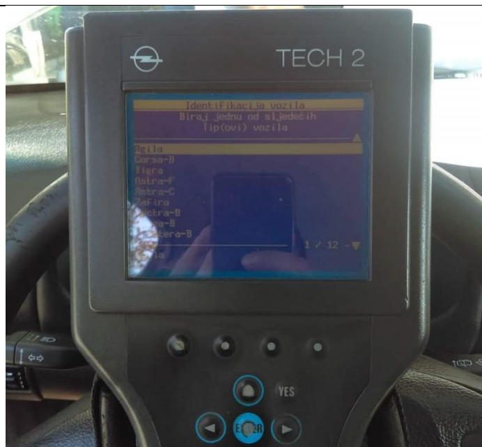
Slika 35. Glavni meni GM Tech-2 dijagnostike
