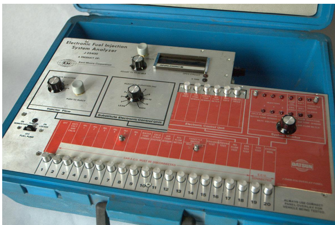
Slika 4. Primjer prvih elektroničkih dijagnostičkih uređaja
