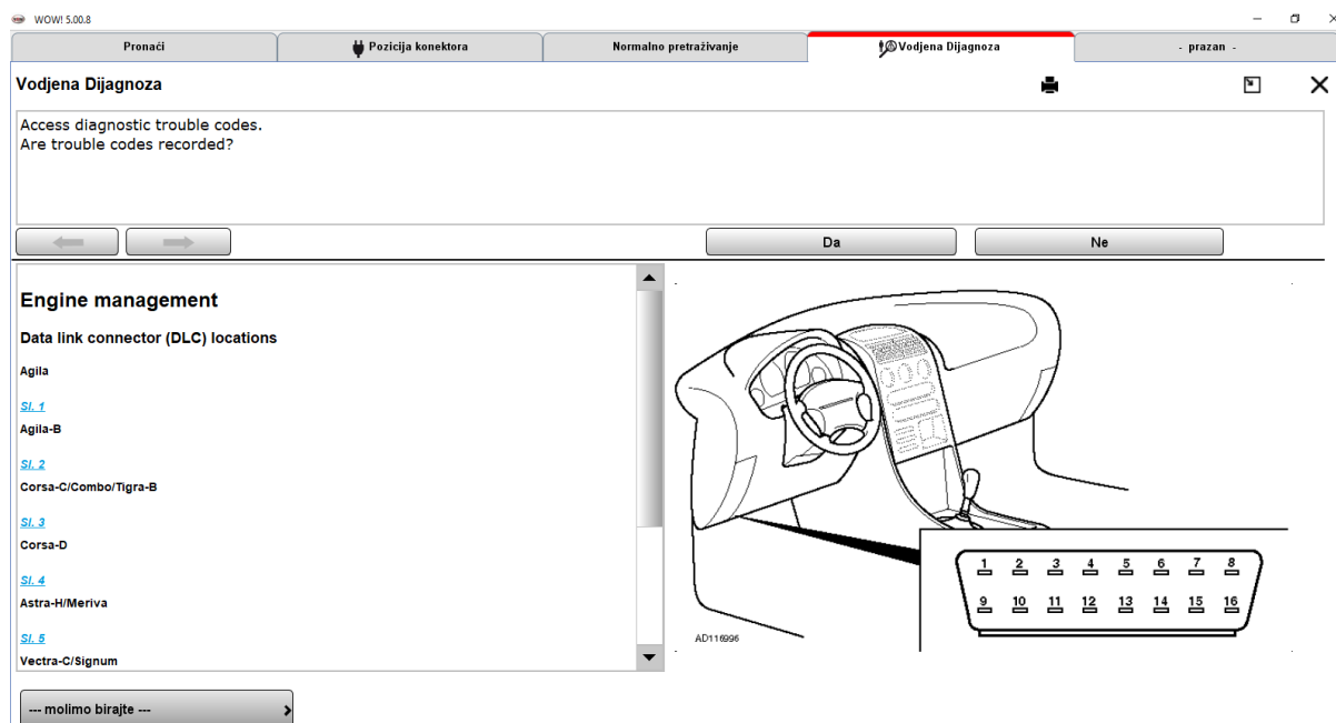
Slika 27. Vođena dijagnostika – upit o statusu koda greške
