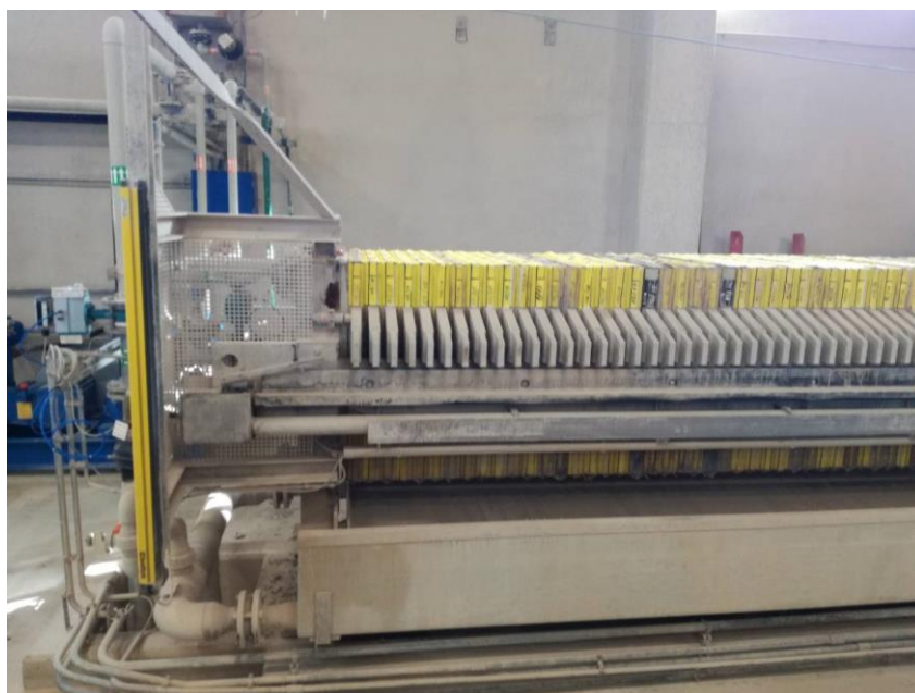
Slika 18. Filterska preša mulja.
