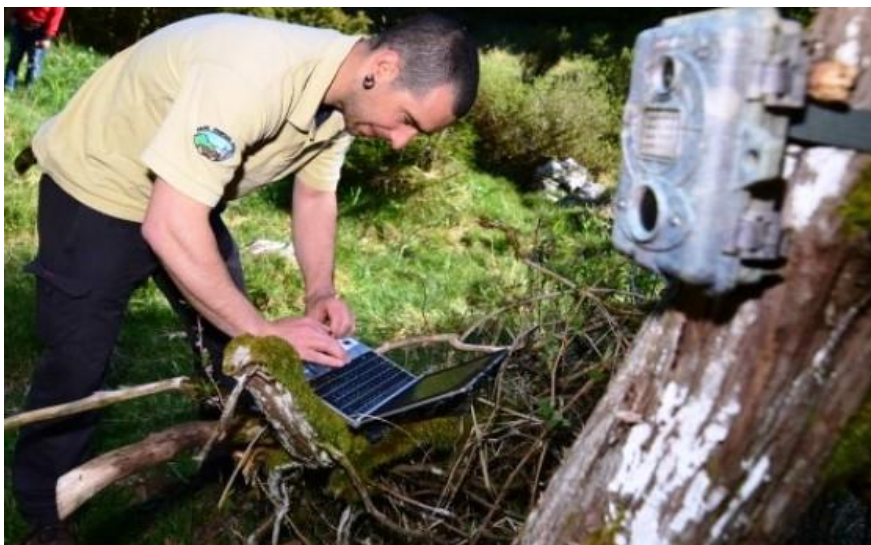
Slika 7: Fotozamka na terenu-skidanje podataka (Foto: Marin Aničić)
