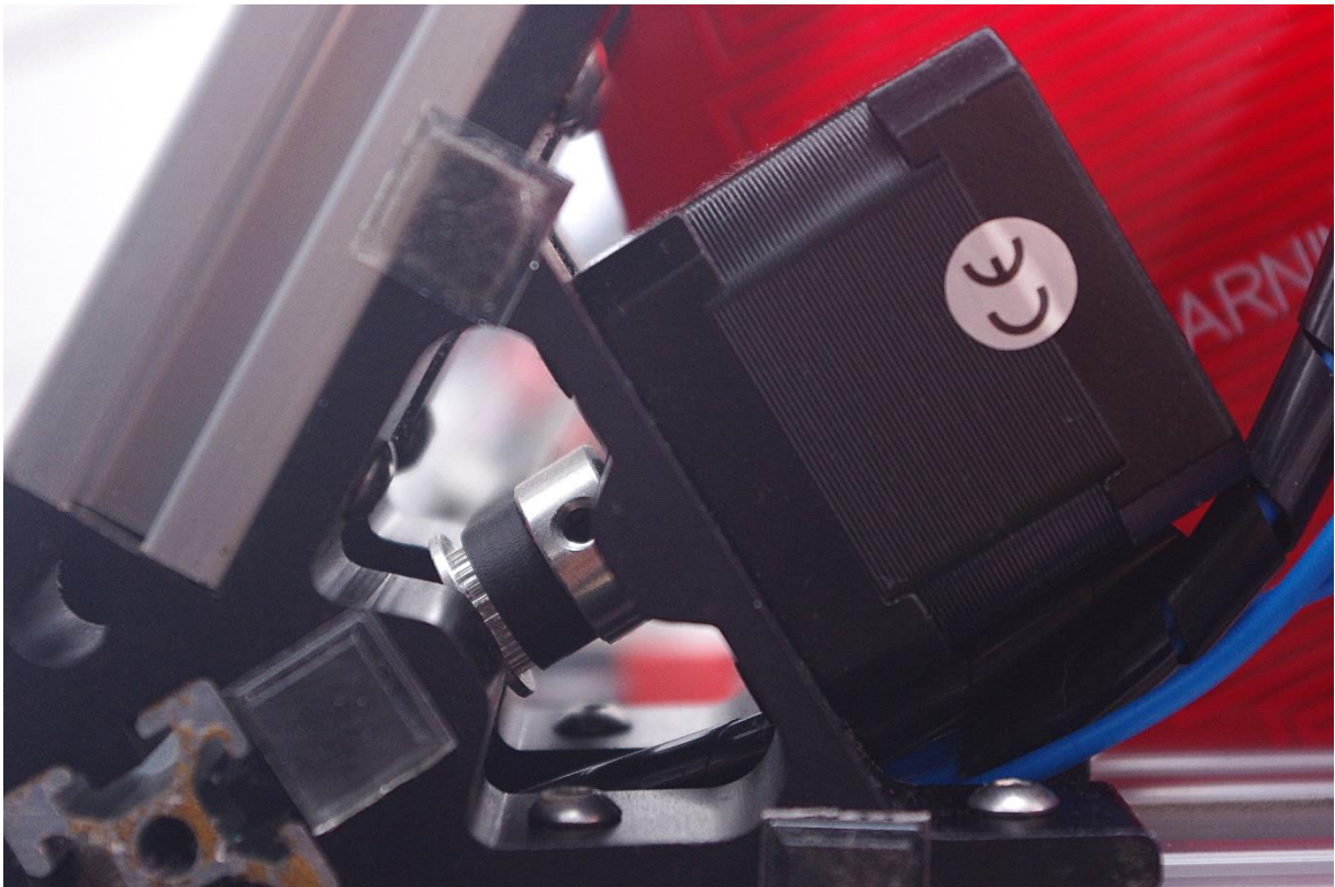
Slika 9. Asihroni koračni motor Nemo 7 sa remenicom od 16 zubaca. Izvor: Rad autora
