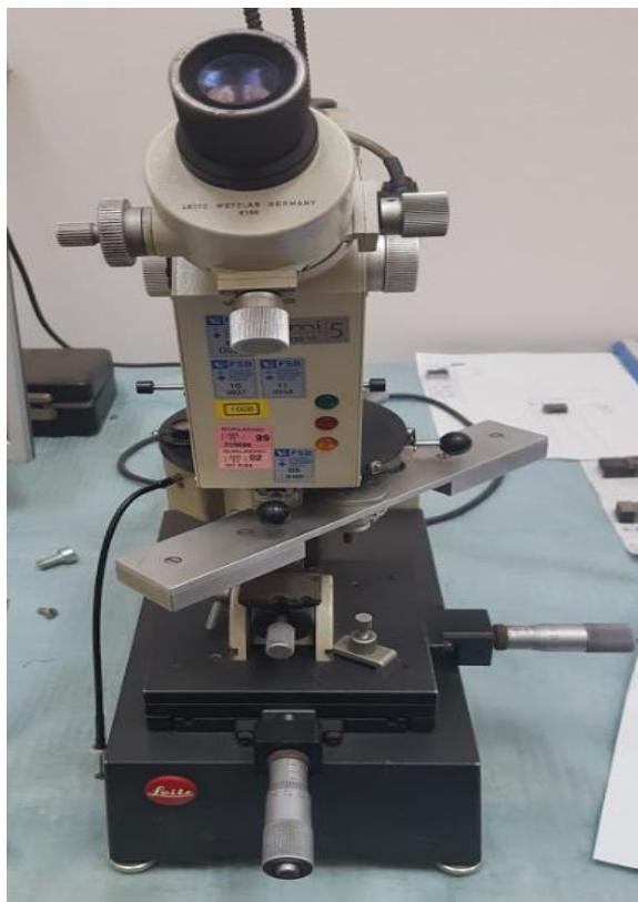
Slika 37: Mikrotvrdomjer Leitz Wetzlar model Durimet 2
