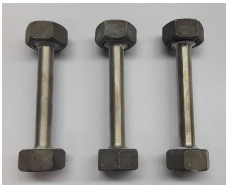
Slika 27: Priprema epruveta za proces nitriranja
