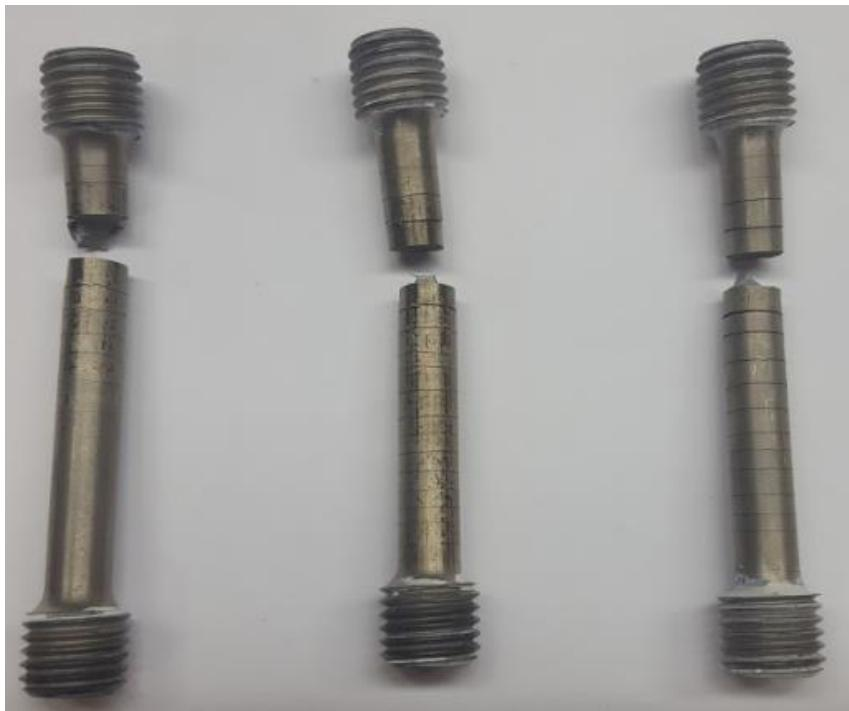
Slika 31: Epruvete nakon vlačnog ispitivanja
