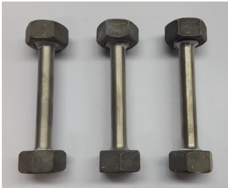
Slika 27: Priprema epruveta za proces nitriranja
