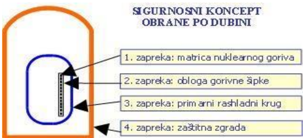
Slika 6. Obrambeni sustav nuklearne elektrane od radioaktivnog zračenja
