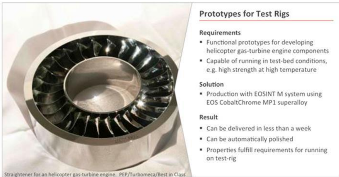
Slika 4.5. Turbina izrađena primjenom aditivne proizvodnje [14]
