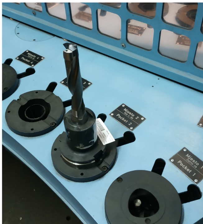
Slika 4.21 Postavljanje alata u odgovarajuće mjesto na stanici za punjenje alata
