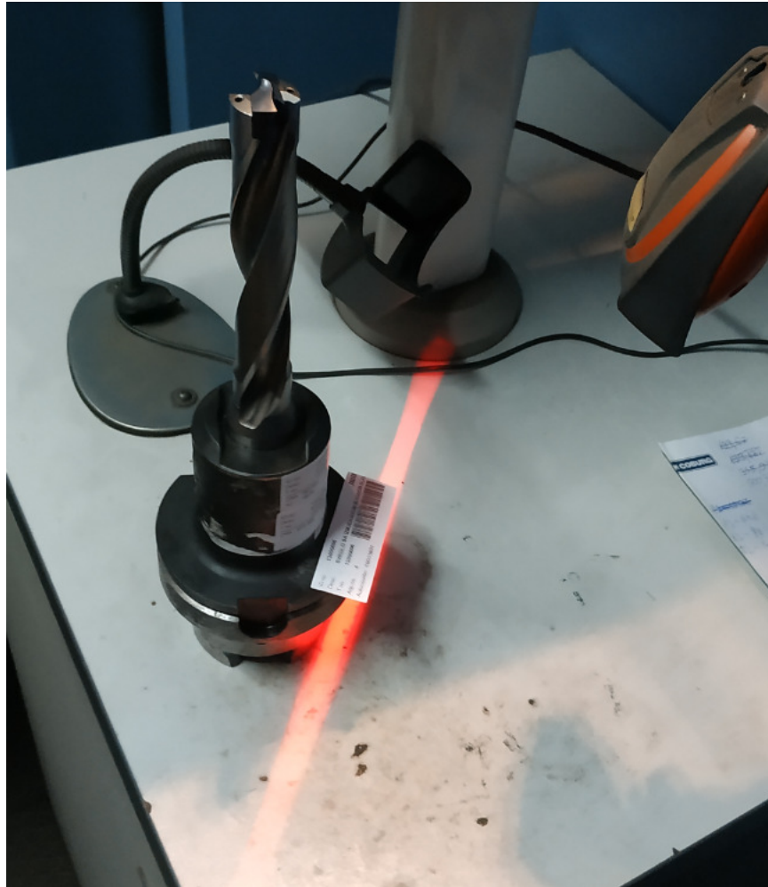
Slika 4.19 Očitavanje jedinstvenog brojevnog naziva pomoću bar-kod čitača
