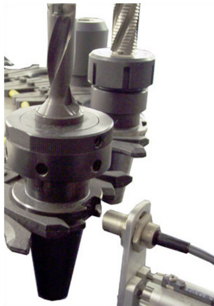
Slika 4.10 RFID čitač na stanici za punjenje alata
