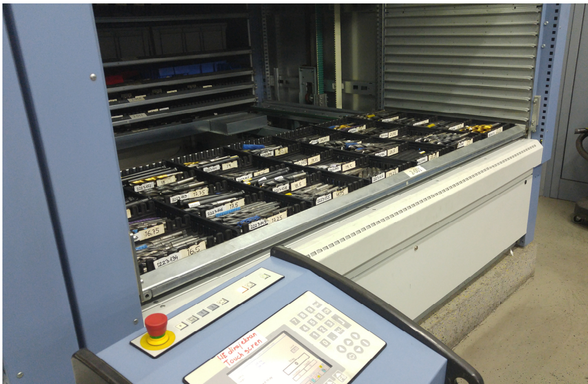
Slika 2.7 Kardex radno sučelje na terminalu s otvorom za izuzimanje
