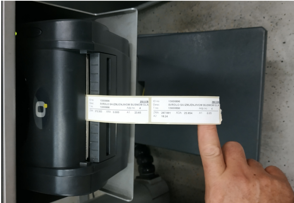
Slika 4.15 Etiketne s izmjerama dužine i promjera alata
