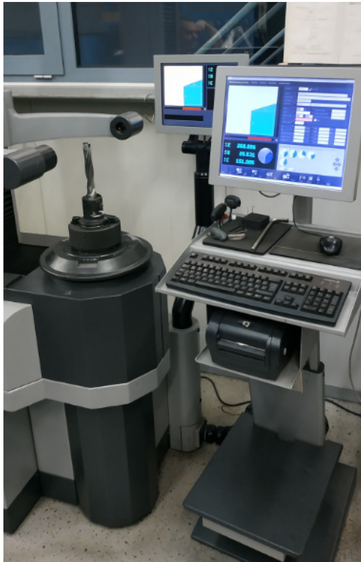
Slika 4.12 Mjerenje alata na uređaju za prednamještanje alata
