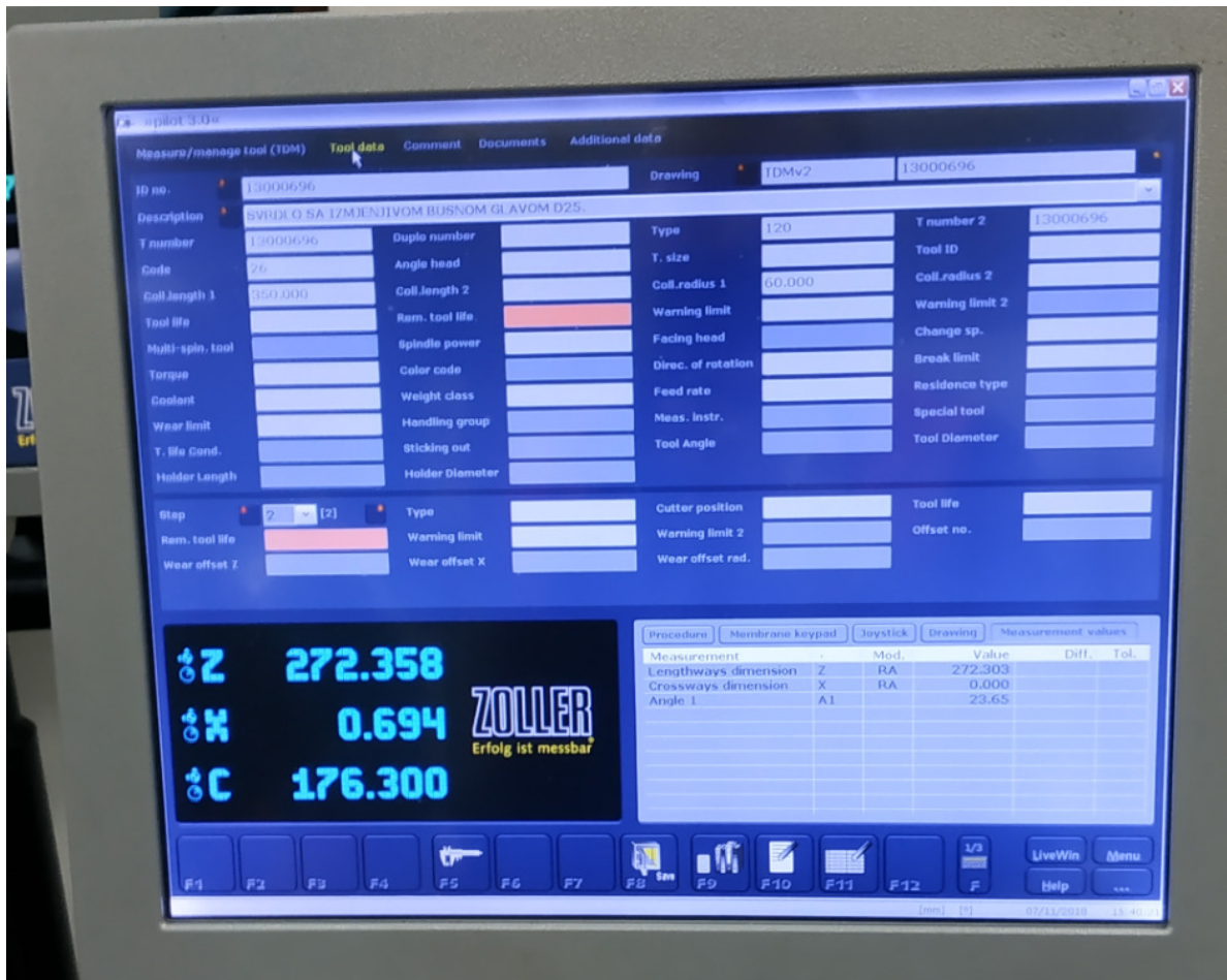
Slika 4.16 Podatci o alatu dobiveni iz TDM-a te uređaja za prednamještanje
