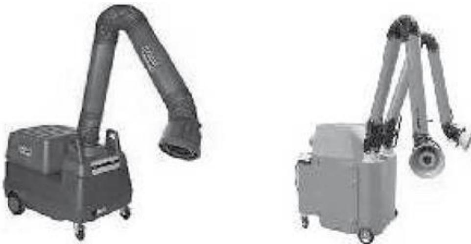
Slika 28. Uređaji za lokalnu ventilaciju u procesu zavarivanja
