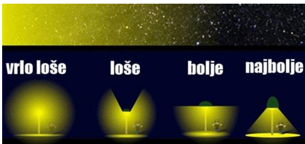
Slika 4. Pravilno postavljanje javne rasvjete
