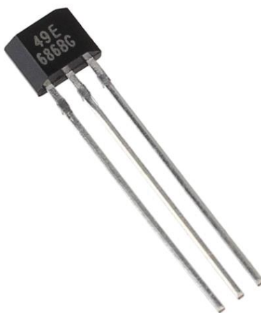
Slika 17.: Primjer Hall-ovog senzora
