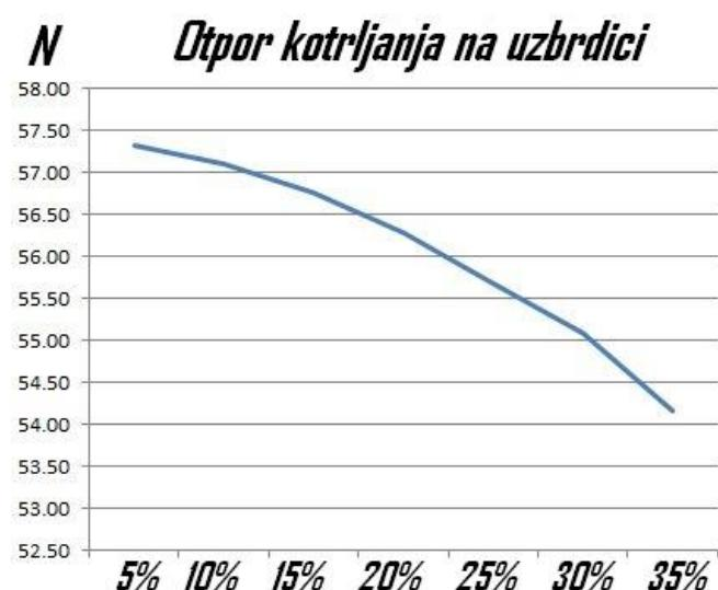
Možemo zaključiti da se s povećanjem nagiba smanjuje otpor kotrljanja uslijed smanjenja djelovanja težine na kotače i podlogu.
