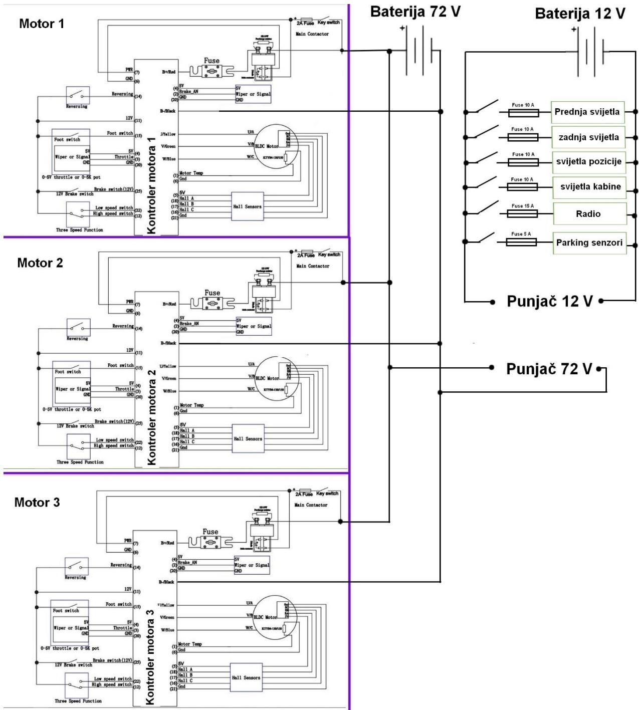
Slika 54.: Električna shema Vozila
