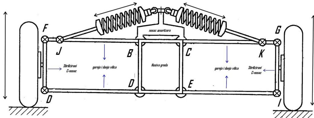
Slika 41.: Shematski prikaz klasičnog ovjesa
