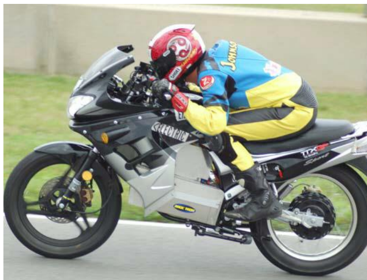
Slika 14. Primjer Hub BLCD motora na motociklu
