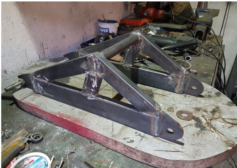
Slika 74.: Zadnja vilica, priprema za daljnju obradu
