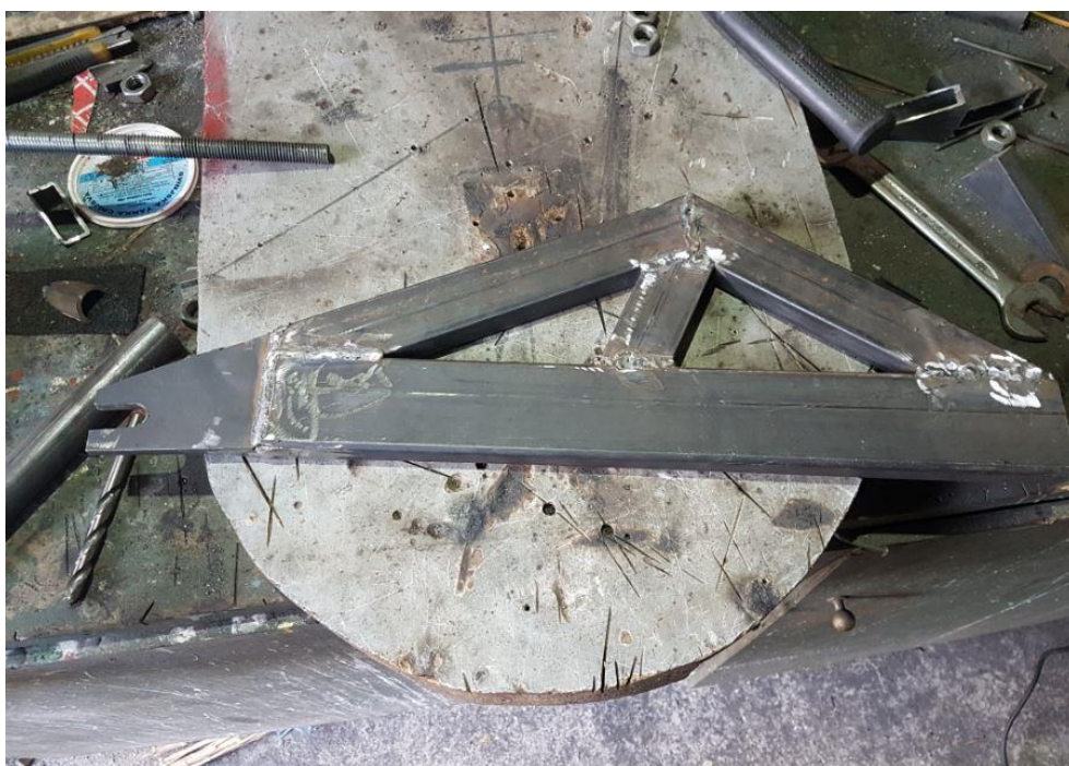
Slika 73.: Zavareni dio zadnje vilice
