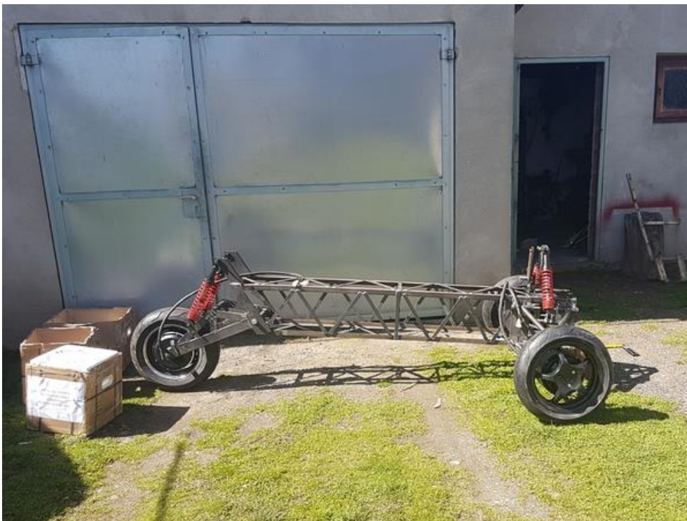
Slika 85.: Prikaz prednjeg i zadnjeg ovjesa montiranih na konstrukciju s motorima i gumama
