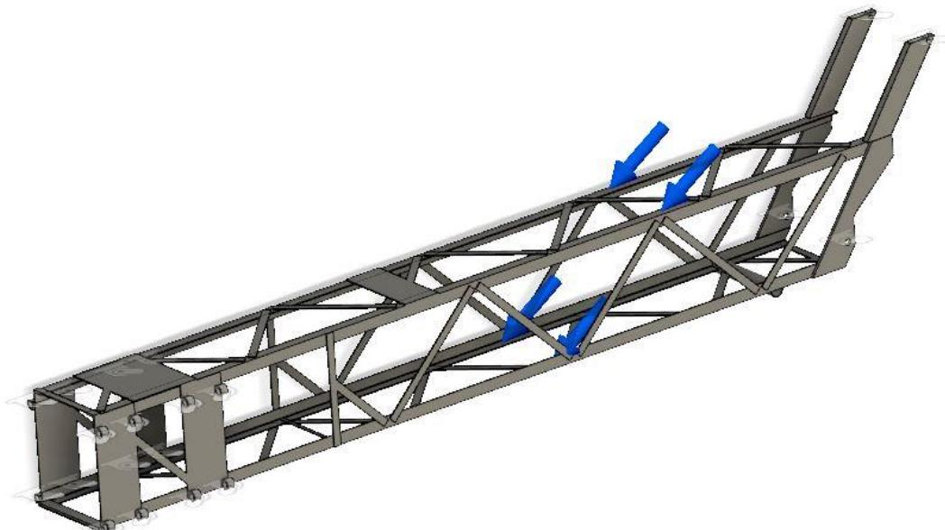
*Slika 55.: Prikaz središnje konstrukcije opterećene pretpostavljenim silama i fiksirani u nosačima vilica*
