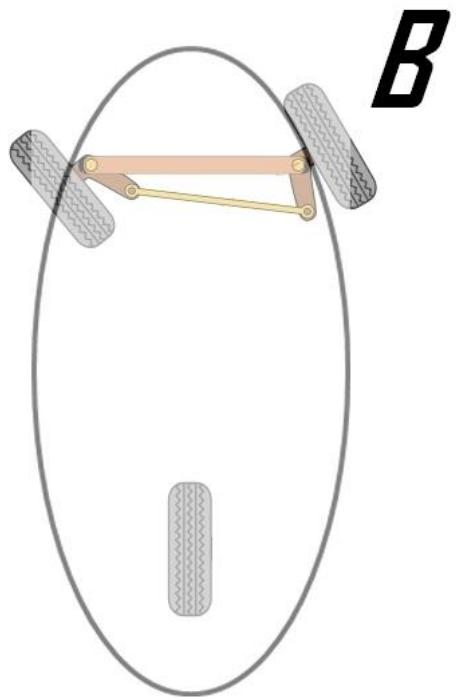
Slika 39.: Shematski prikaz upravljanja oko z-osi (zakretanje kotača)
