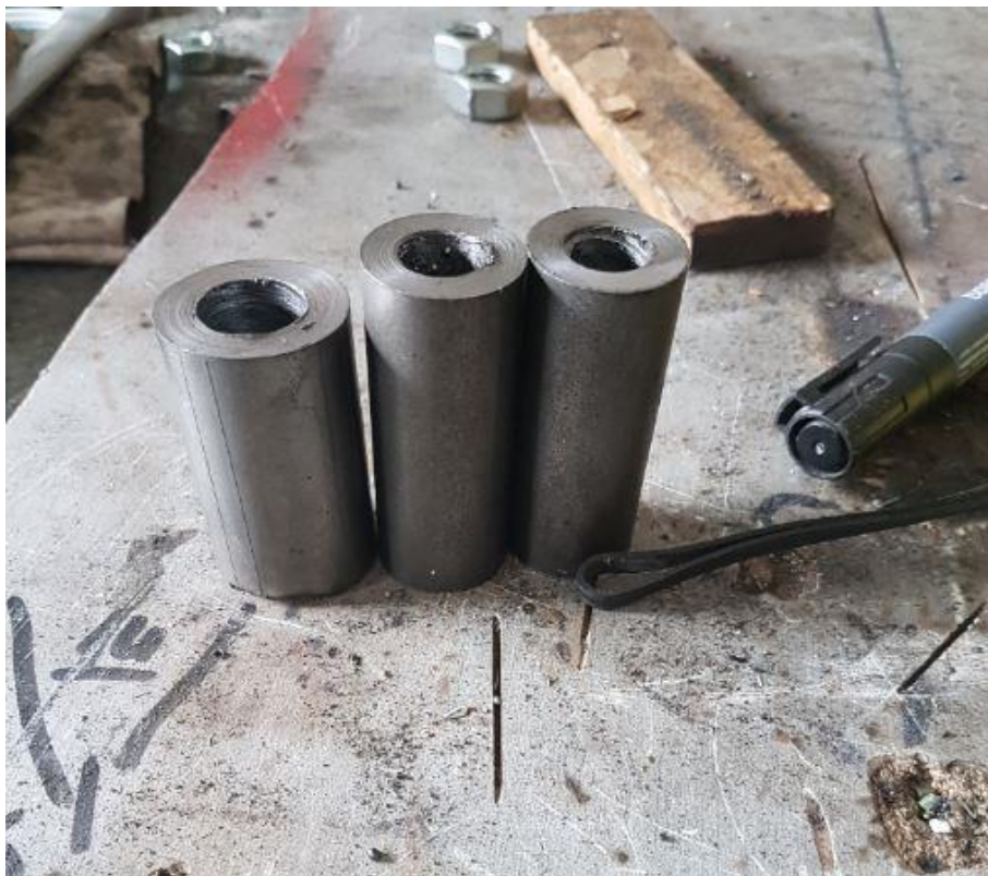
Slika 70.: Dijelom obrađeni nosači osovina
