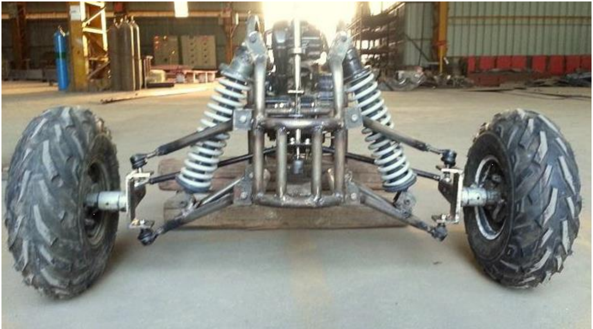
Slika 40.: Primjer ovjesa kod ATV vozila
