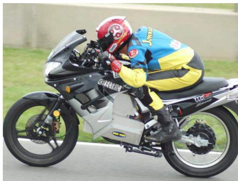
Slika 14. Primjer Hub BLCD motora na motociklu
