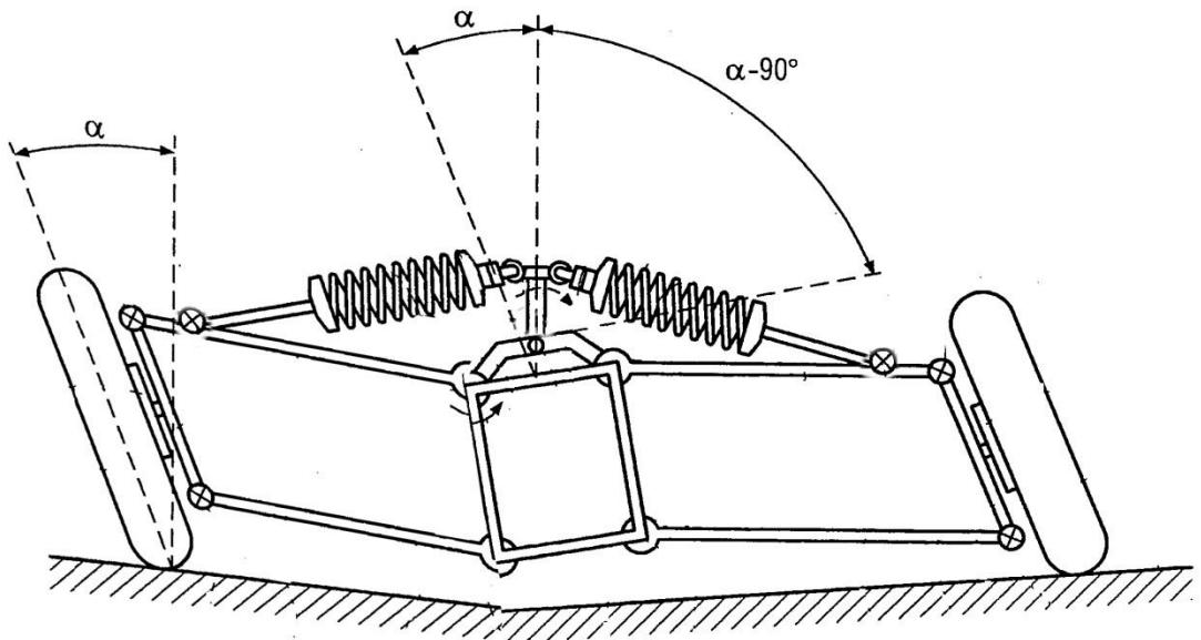
Slika 45.: Shematski prikaz nagnutog vozila prilikom nailaska na prepreku
