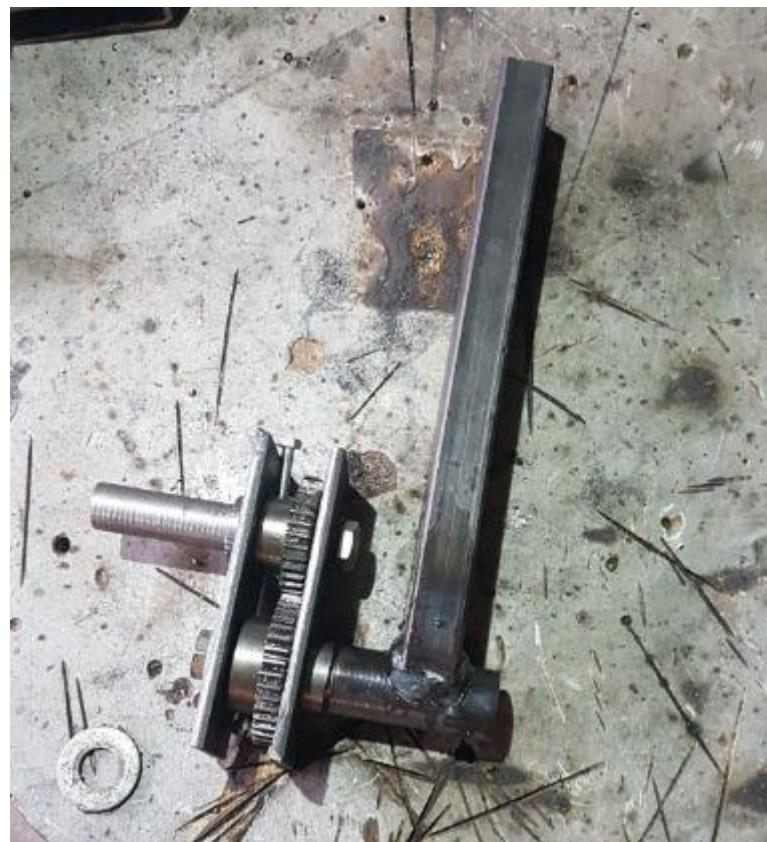
*Slika 80.: Izrada mjenjačkog mehanizma*
