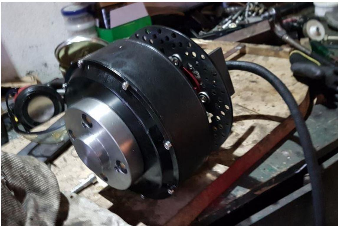
Slika 79.: Montaža flanđe na motor
