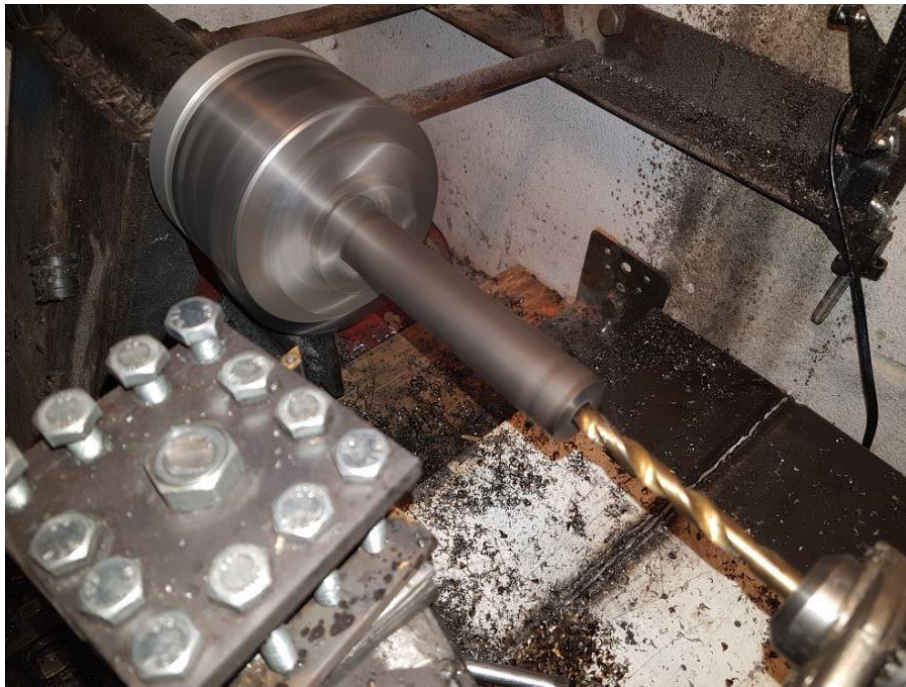
Slika 69.: Izrada nosača osovina na tokarskom stroju
