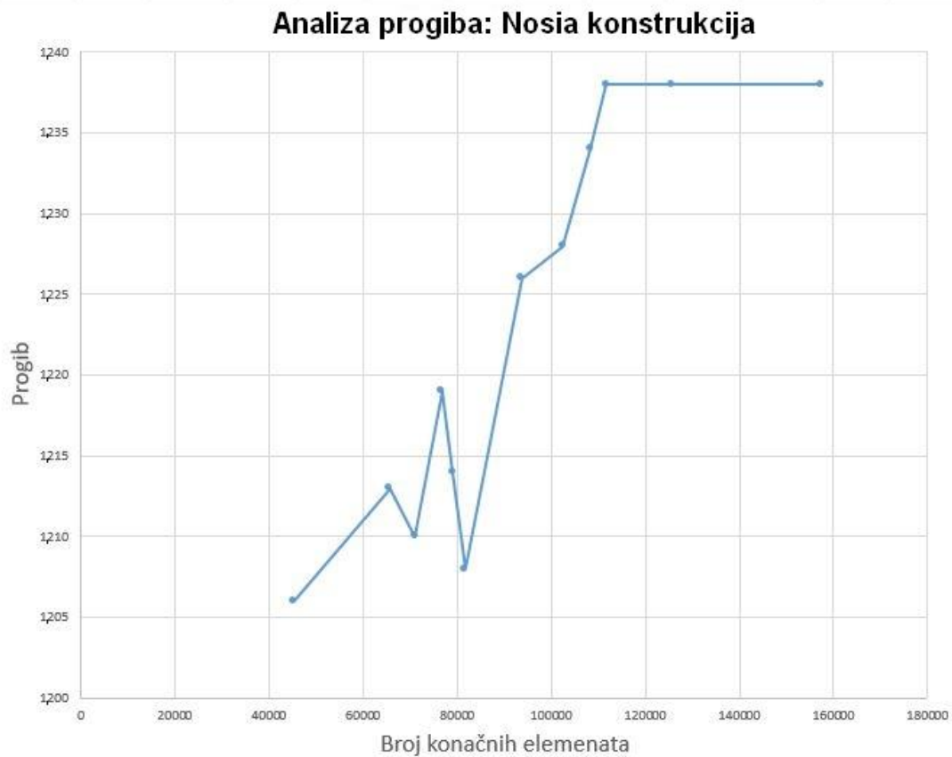
Dijagram 20.: FEM analiza progiba u zavisnosti o broju konačnih elemenata – nosiva konstrukcija
