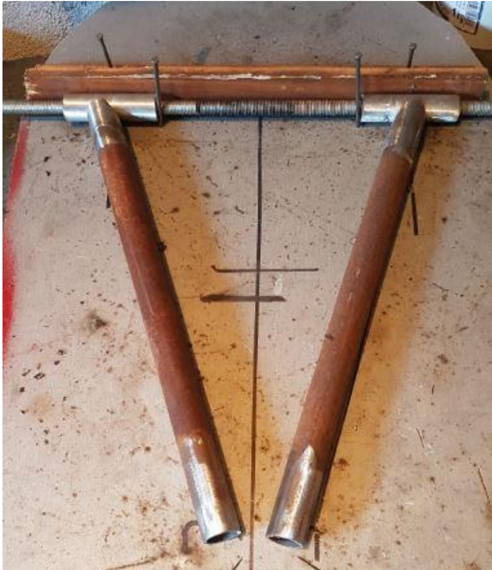
Slika 71.: Priprema za zavarivanje prednje vilice
