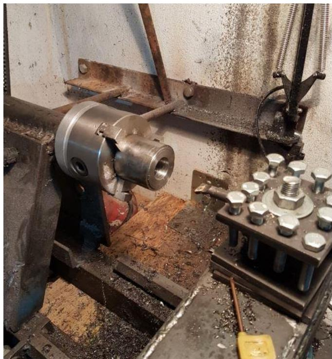
Slika 75.: Tokarenje provrta osovine za elektromotor
