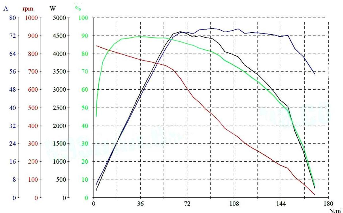
Tablica 7.: Karakteristike odabranog QS motora (jedan od 3 motora)
