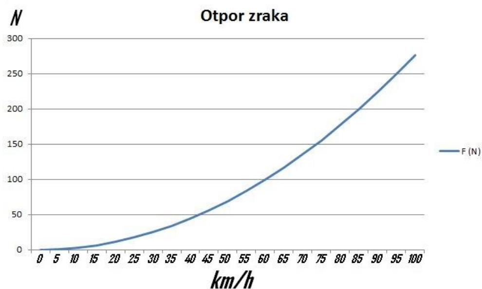
Dijagram 5.: otpor zraka u zavisnosti od brzine
