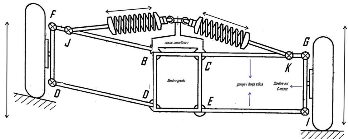
Slika 42.: Shematski prikaz klasičnog ovjesa pri amortizaciji hupsera/prepreke
