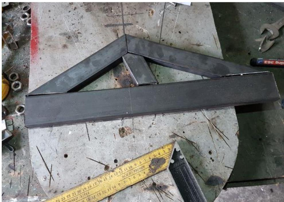
Slika 72. Priprema za zavarivanje zadnje vilice
