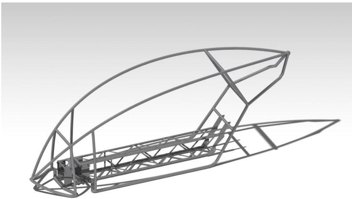
Slika 28.: Osnovna nosiva konstrukcija
