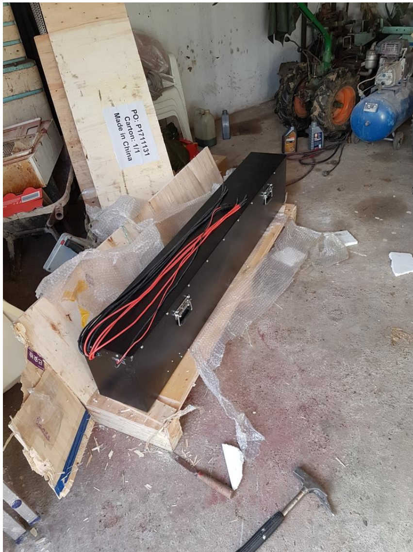
Slika 86.: Baterija vozila 72V 100 Ah
