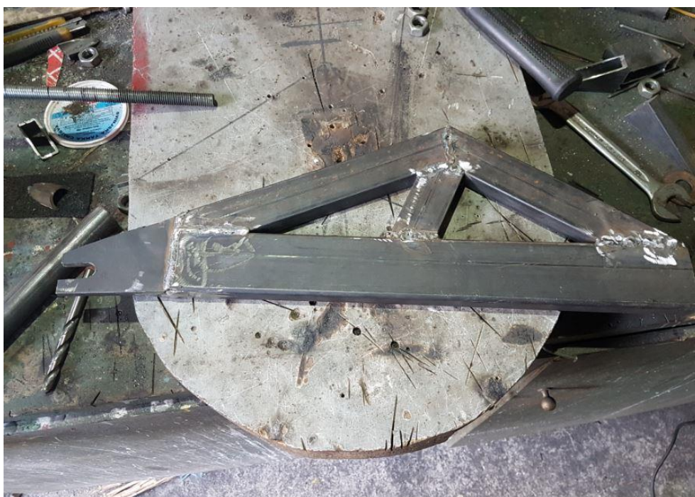
Slika 73.: Zavareni dio zadnje vilice
