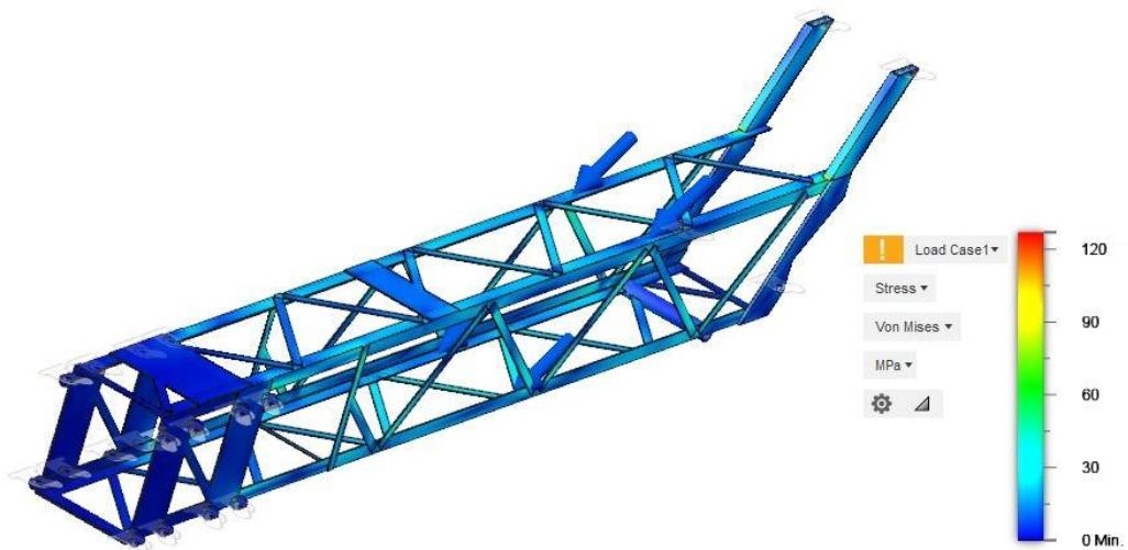
Slika 56.: Naprezanje na nosivi dio konstrukcije
