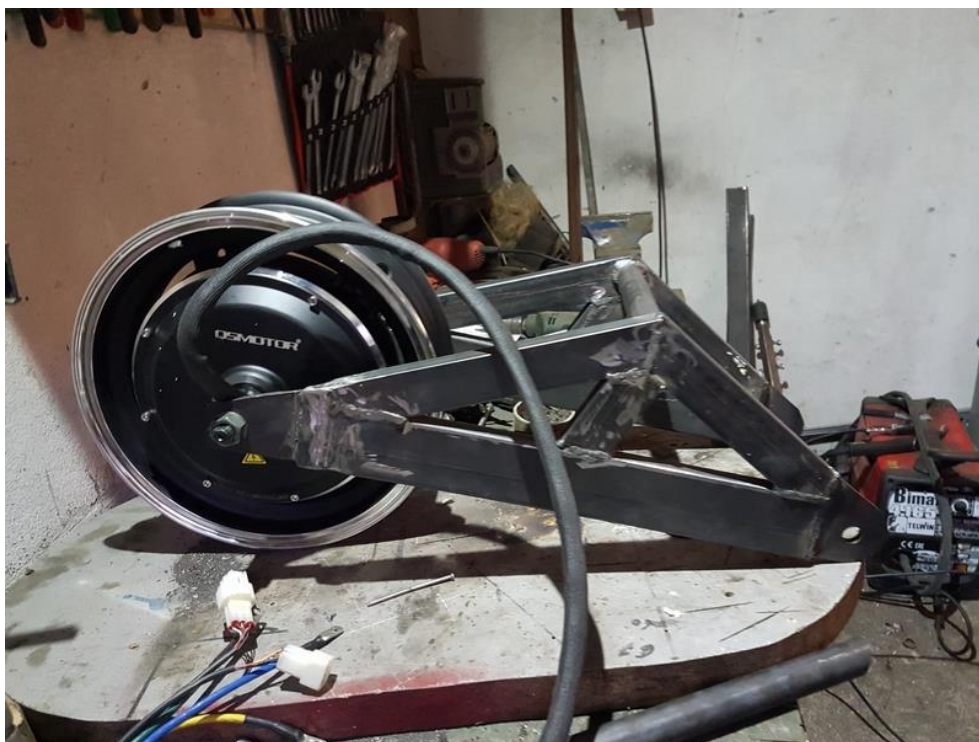
Slika 83.: montaža zadnjeg motora na zadnju vilicu ovjesa
