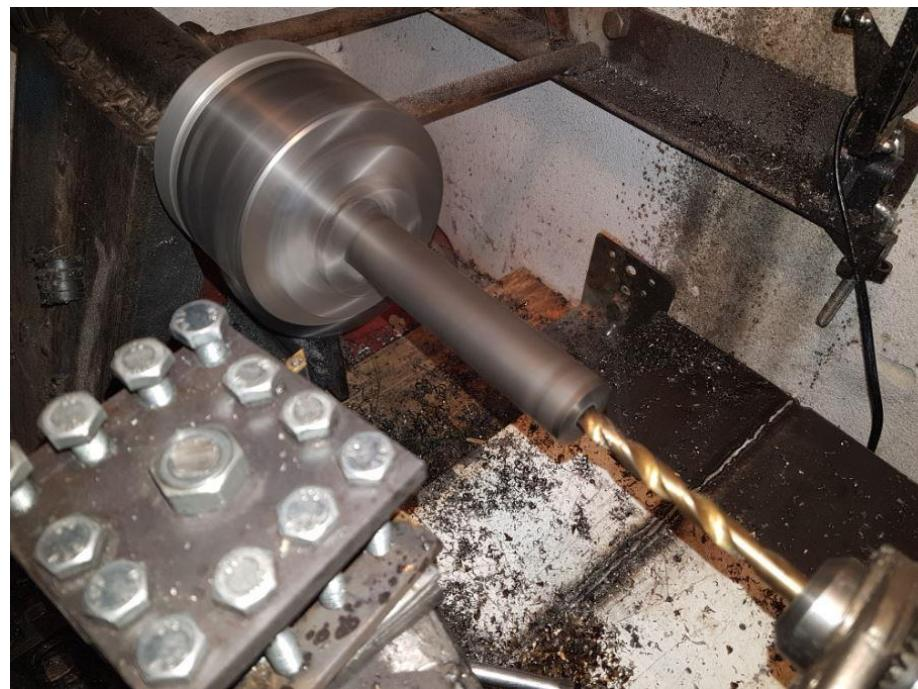
Slika 69.: Izrada nosača osovina na tokarskom stroju
