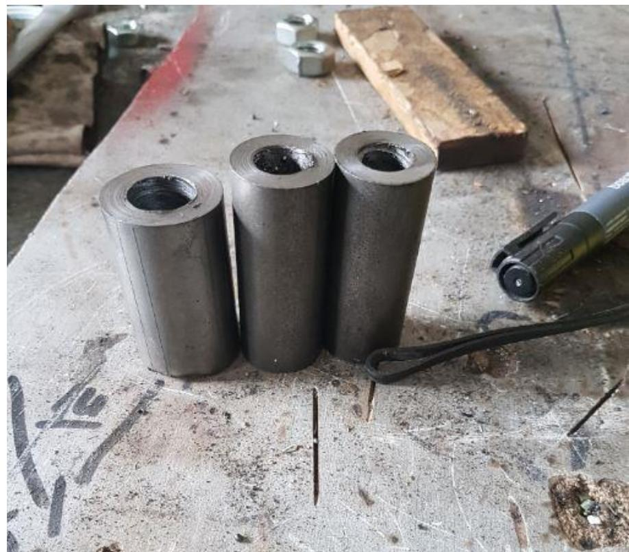
Slika 70.: Dijelom obrađeni nosači osovina
