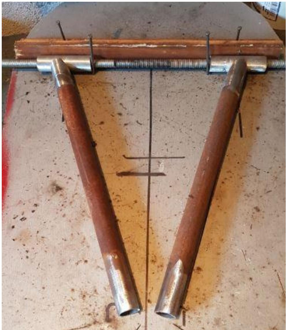
Slika 71.: Priprema za zavarivanje prednje vilice
