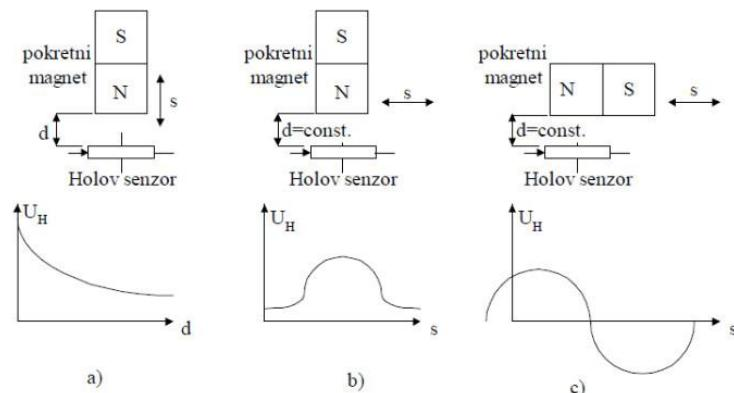
Slika 16. Mjerenje pomaka Hall-ovim senzorima: a) magnet se pomjera normalno na pločicu, b) i c) magnet se kreće paralelno sa pločicom
