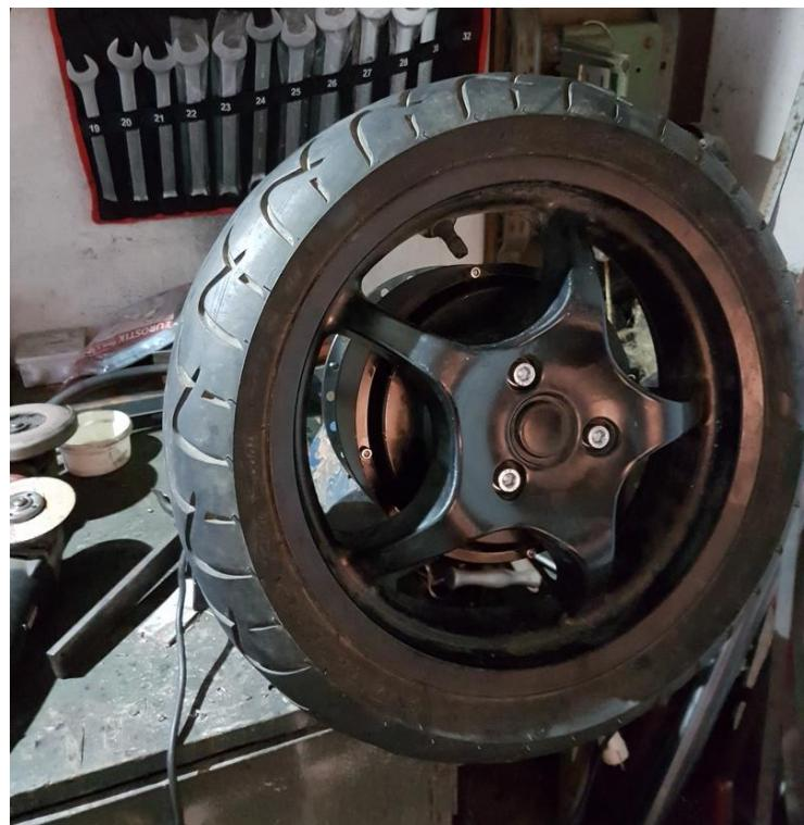
Slika 82.: Montaža gume i felge na flandžu motora
