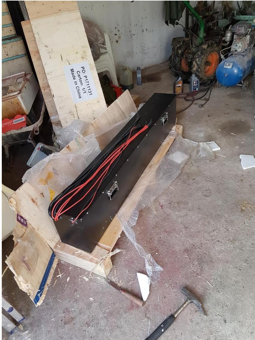
Slika 86.: Baterija vozila 72V 100 Ah
