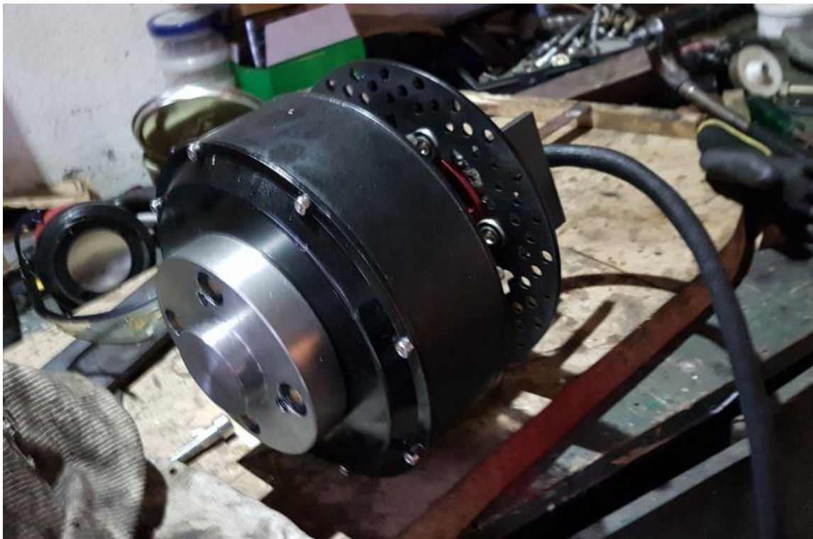
Slika 79.: Montaža flande na motor
