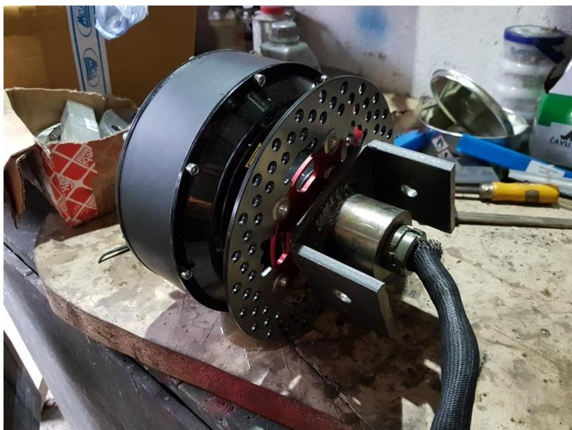
*Slika 81.: Montaža prednjeg motora na C-nosač*
