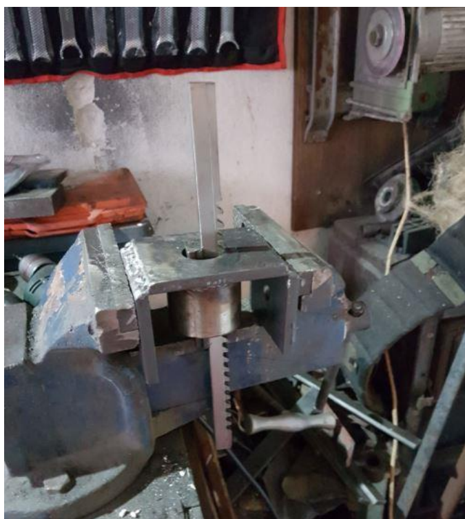
Slika 76.: Provlačenje provlačila za izradu utora za klin
