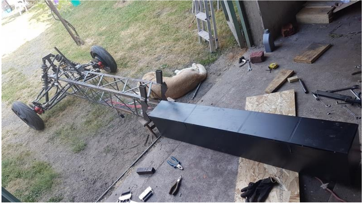
Slika 88.: Priprema za montažu baterije
