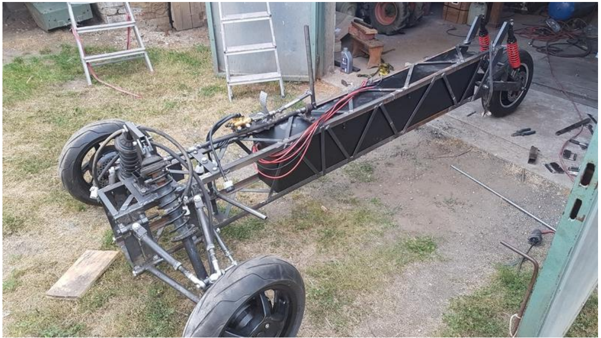
Slika 90.: Montirana baterija unutar konstrukcije
