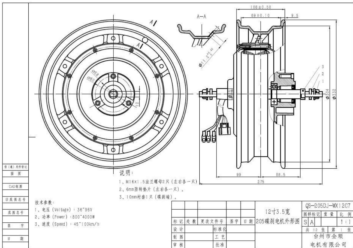
Slika 24.: QS Motor 12\*3.5inch 205 3000W 50H V3 dimenzije
