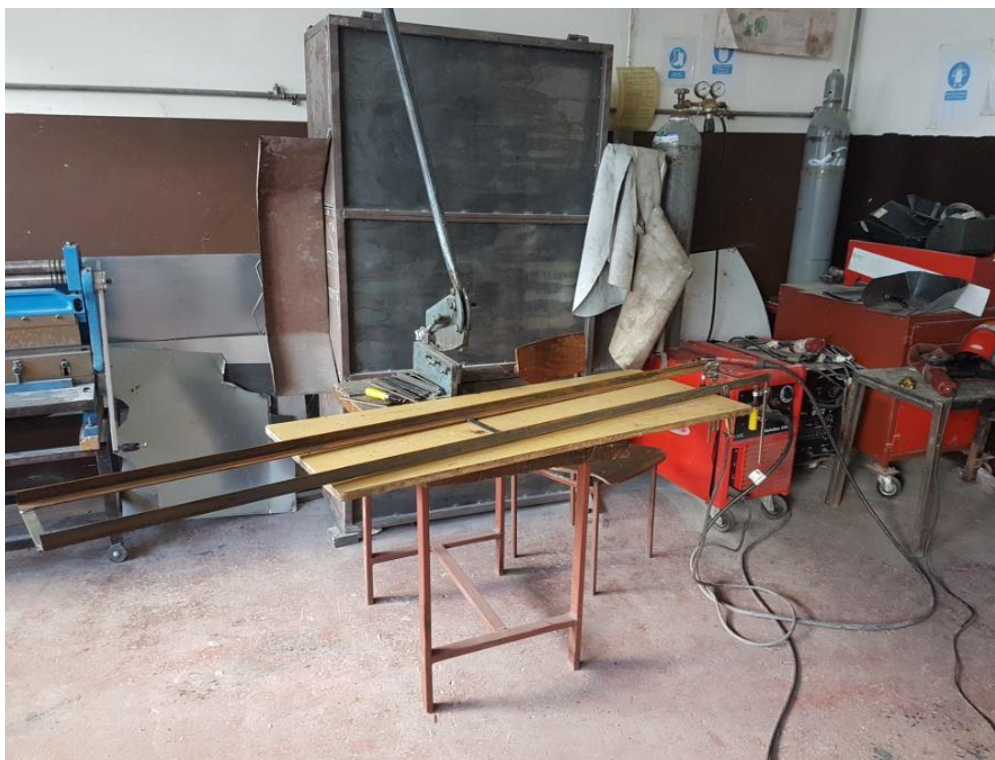
Slika 63.: Priprema za spajanje komponenata nosive konstrukcije
