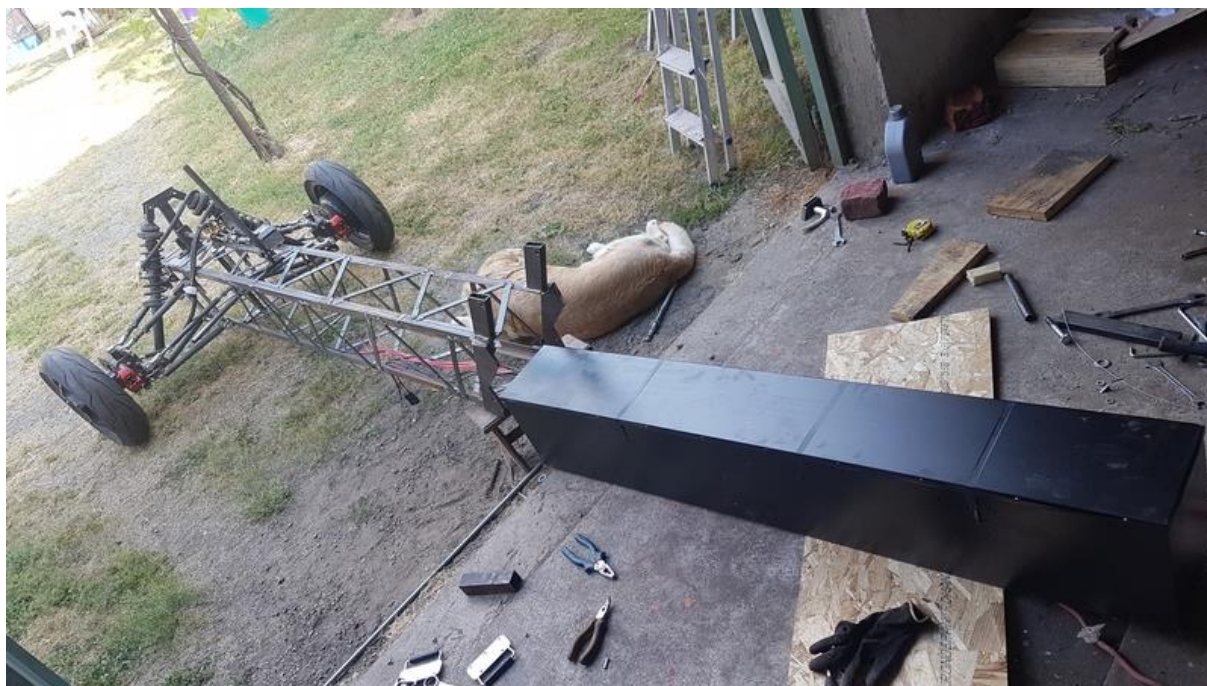
Slika 88.: Priprema za montažu baterije
