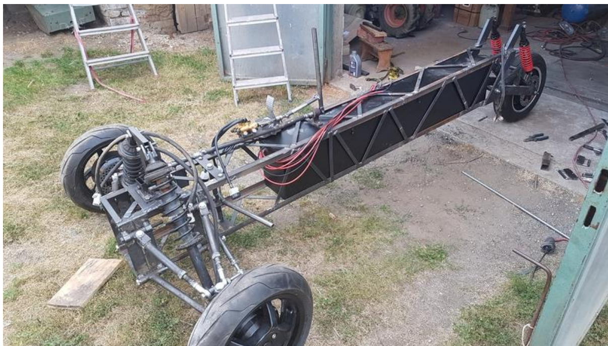
Slika 90.: Montirana baterija unutar konstrukcije
