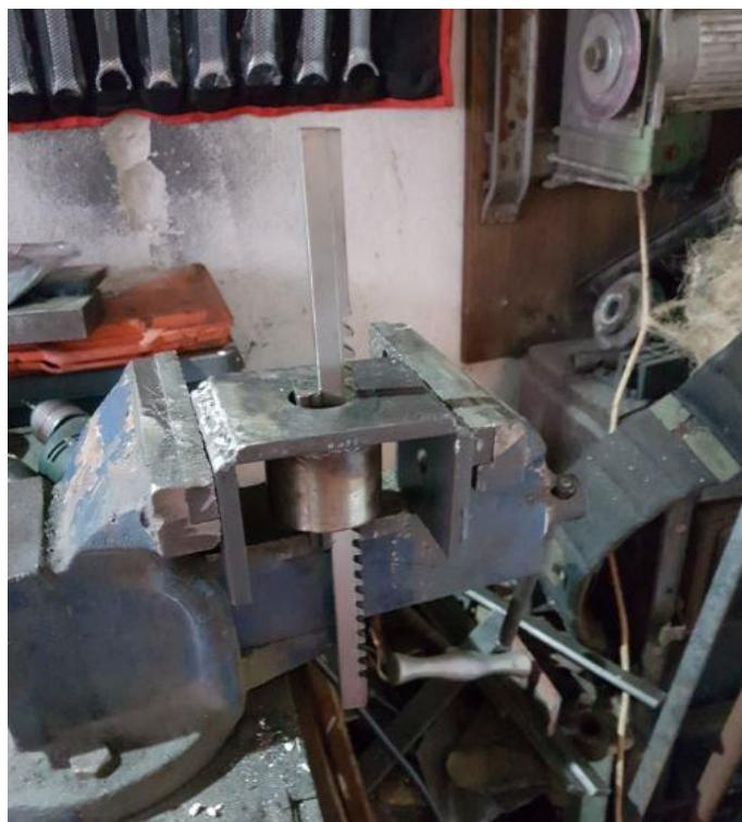
Slika 76.: Provlačenje provlačila za izradu utora za klin
