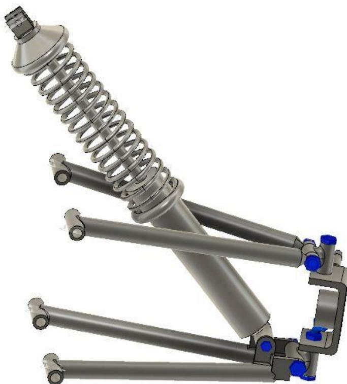
Slika 60.: prednji ovjes fiksiran u karakterističnim točkama i opterećen prepostavljenim silama
