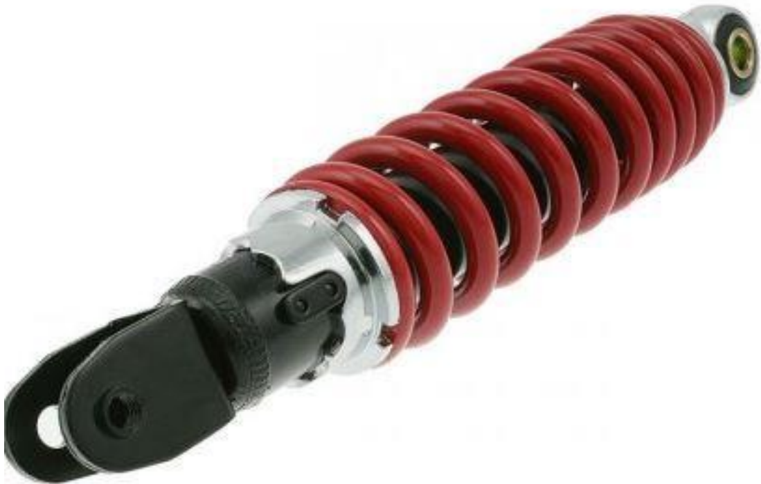
Slika 34.: Amortizer s oprugom za amortizaciju zadnjeg kotača (2 kom, Yamaha 500)
