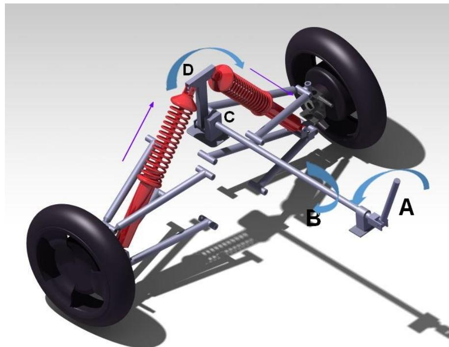
Slika 47.: Sustav upravljačkog mehanizma za nagib vozila
