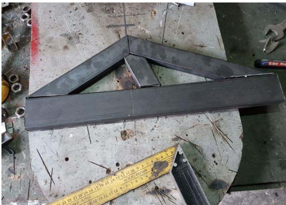
Slika 72. Priprema za zavarivanje zadnje vilice
