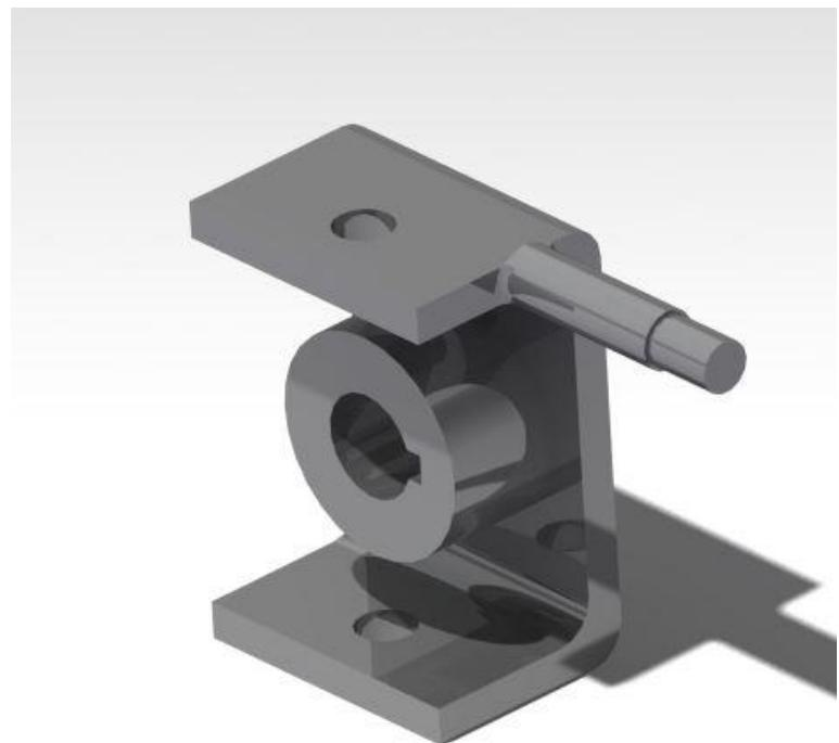
Slika 32.: C-nosač osovine motora
