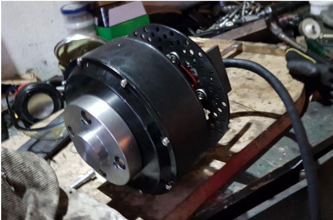
Slika 79.: Montaža flande na motor
