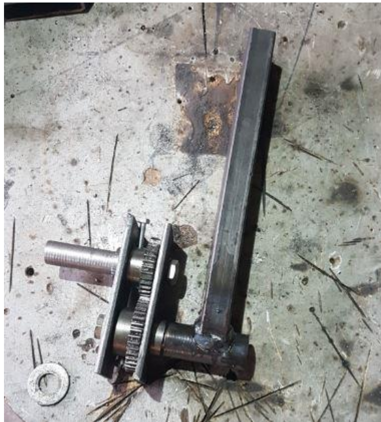
Slika 80.: Izrada mjenjačkog mehanizma
