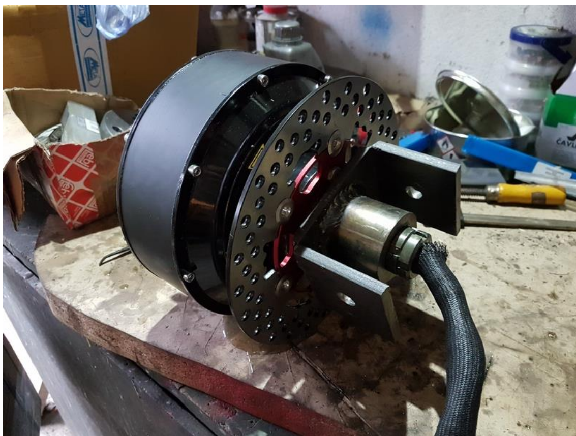
Slika 81.: Montaža prednjeg motora na C-nosač
