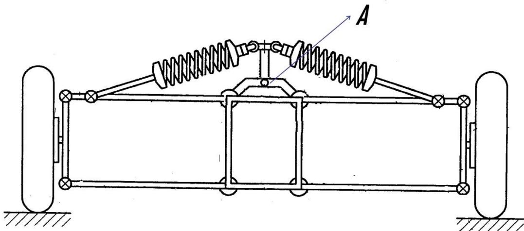
Slika 43.: shematski prikaz ovjesa kojem je dodan stupanj slobode rotacije oko točke A
