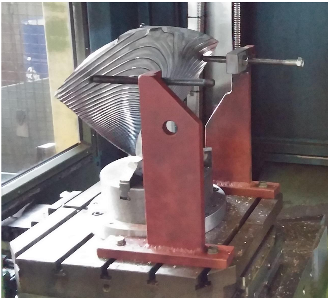
Slika 42. Stezanje sa zategama
