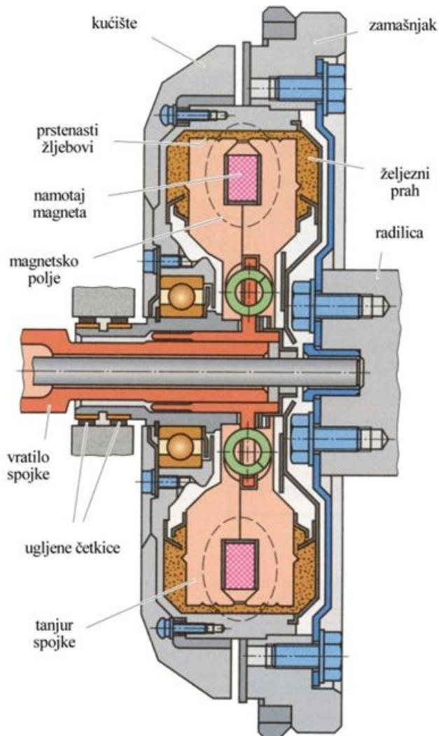
Slika 17. elektromagnetska spojka
