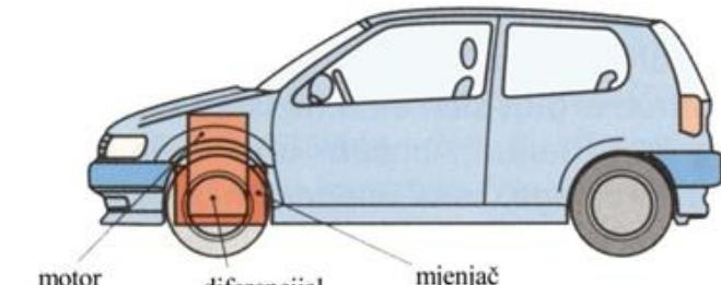
**poprečni motor na prednjoj osovini**
