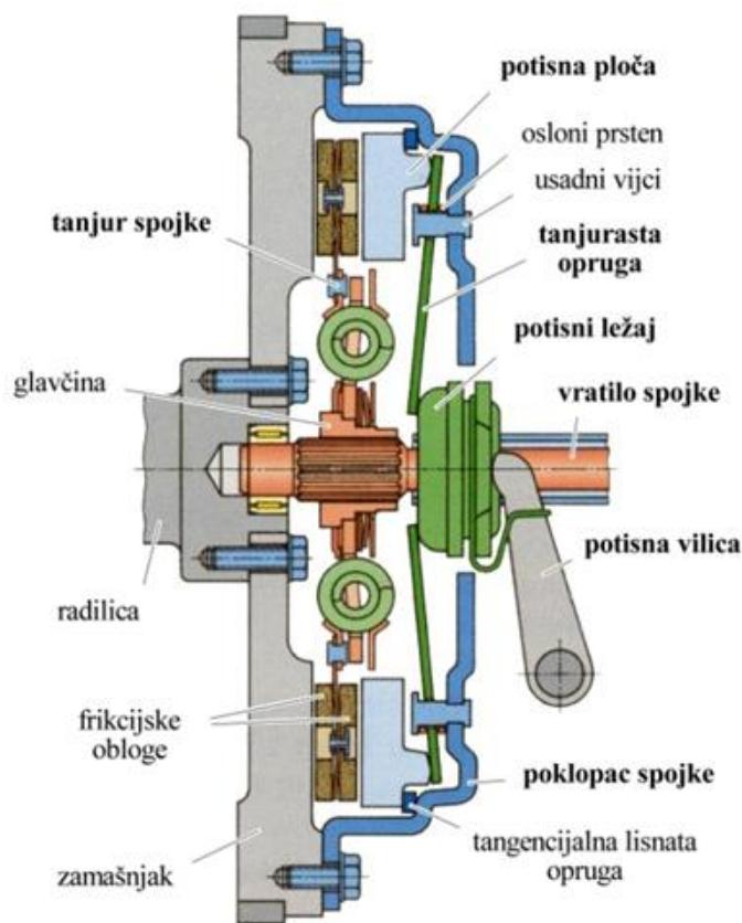
Slika 8. Konstrukcija tarne spojke s jednim tanjurom
