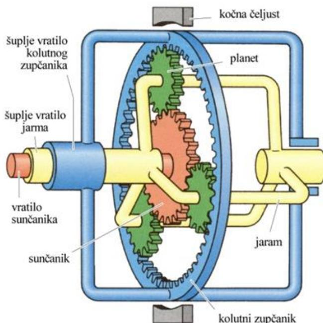
Slika 19. jednostavni planetarij
