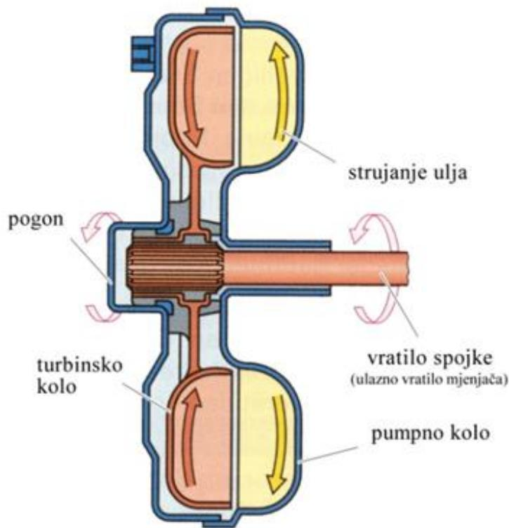
Slika 16. hidrodinamička spojka
