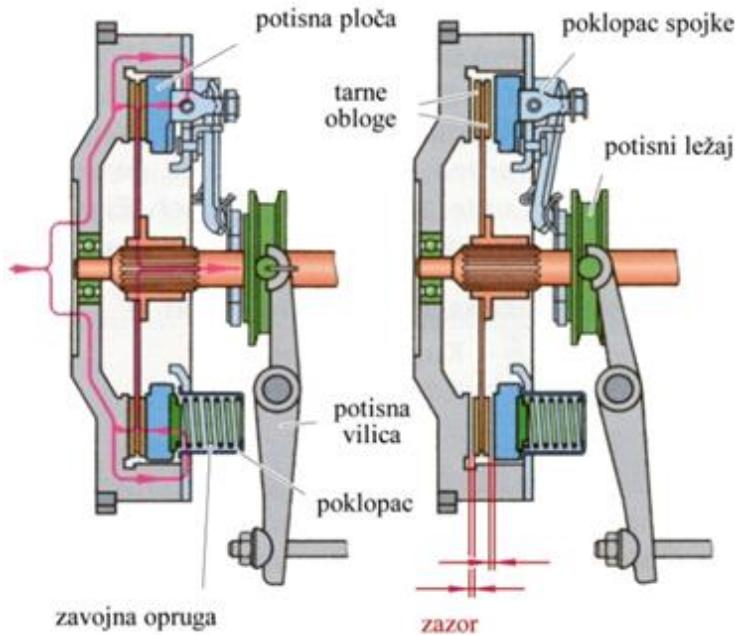
Slika 10. spojka sa zavojnim oprugama
