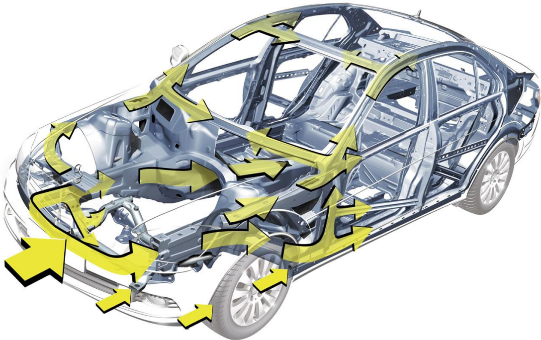
Slika 26. Deformacijske zone - preduvjet za crash-test
