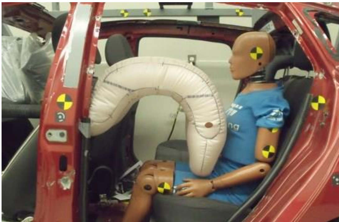
Slika 29. Prikaz djelovanja stražnjih zračnih jastuka
