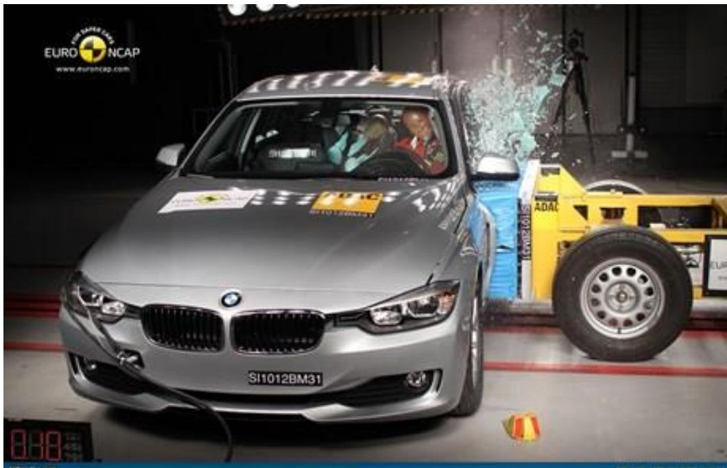
Slika 17. Testiranje na bočni udar
