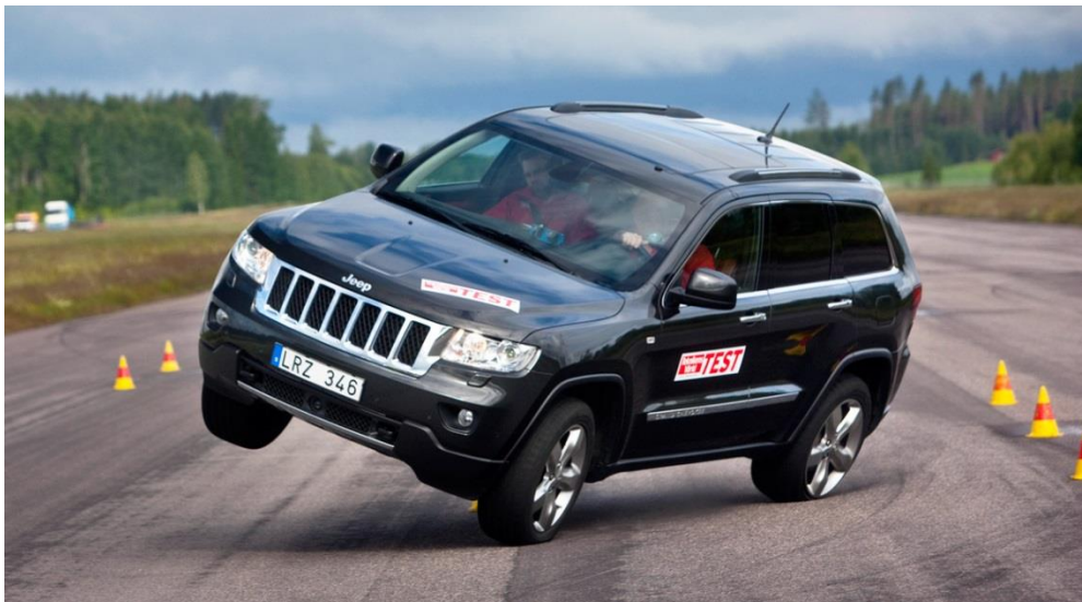
Slika 19. Prikaz djelovanja ESP sustava
