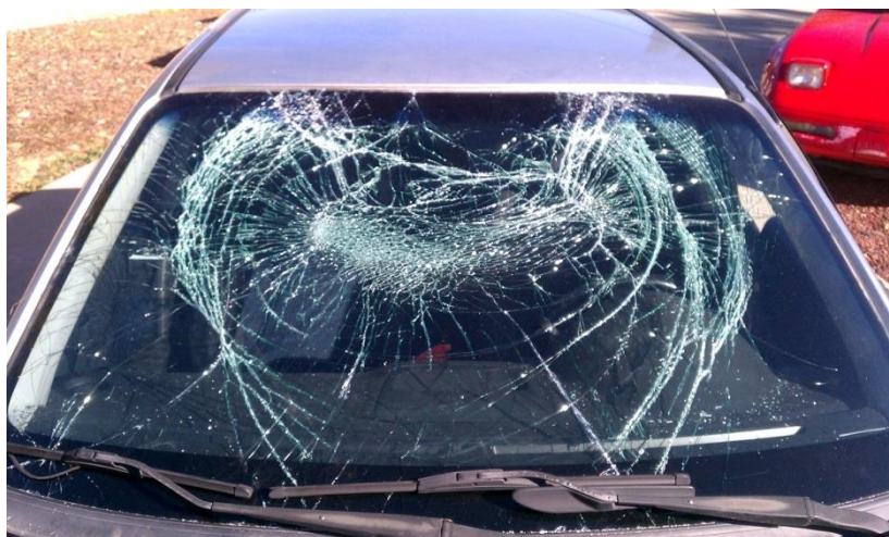
Slika 21. Laminirano staklo nakon udara
