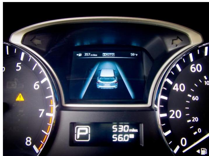
Slika 28. LDW sustav na kontrolnoj ploči
