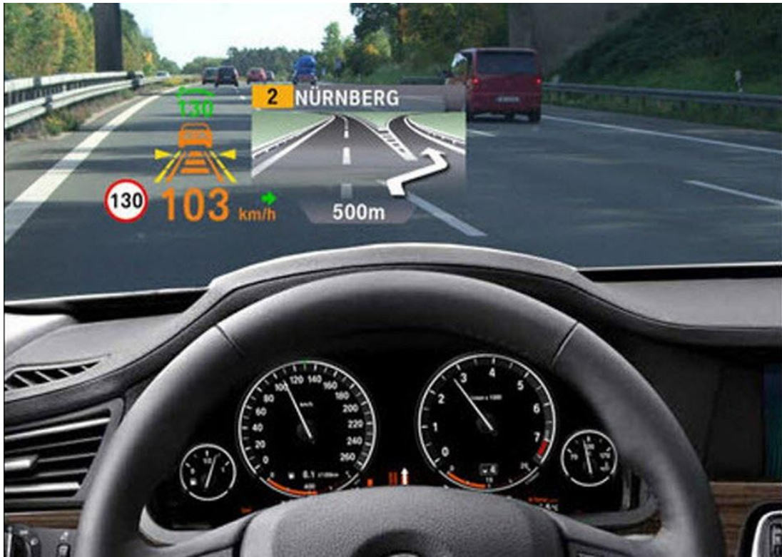
Slika 34. Prozirni ekran HUD sustava
