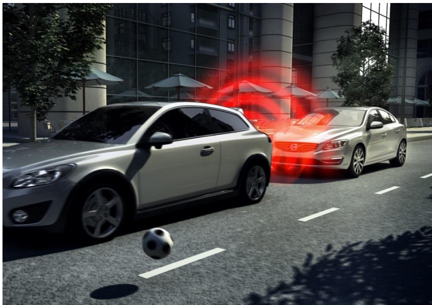
Slika 32. Sustav autonomnog kočenja
