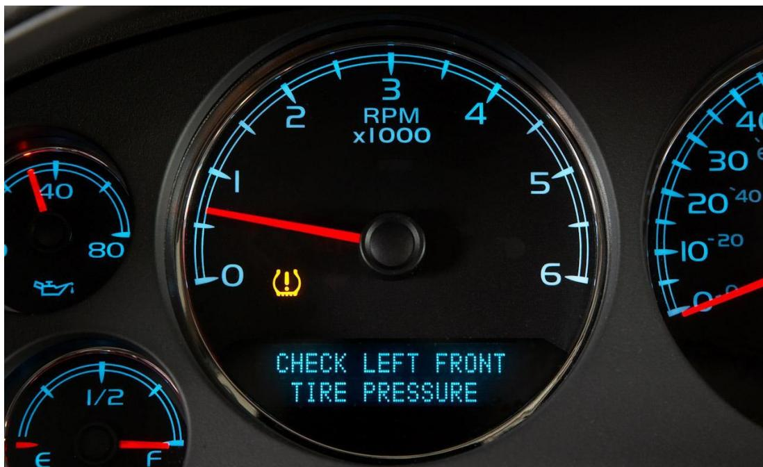
Slika 30. TPMS sustav na kontrolnoj ploči
