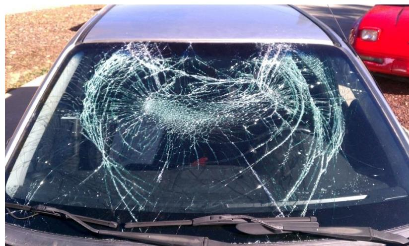
Slika 21. Laminirano staklo nakon udara
