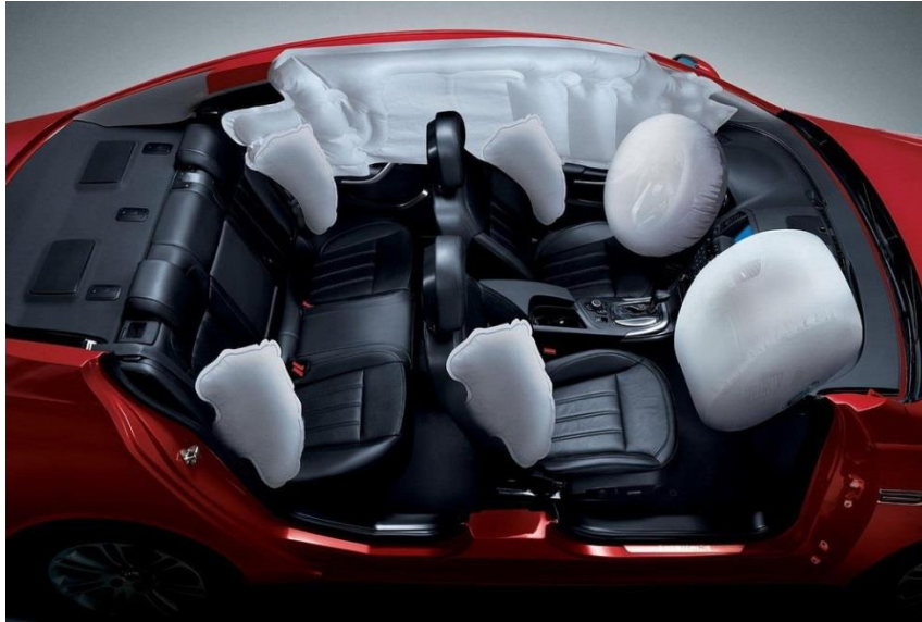
Slika 20. Prikaz djelovanja airbeg sustava
