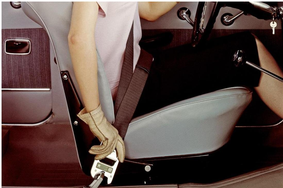
Slika 22. Pojas s pričvršćenjem u tri točke
