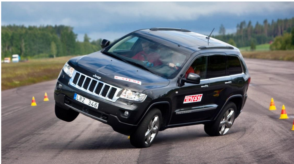
Slika 19. Prikaz djelovanja ESP sustava
