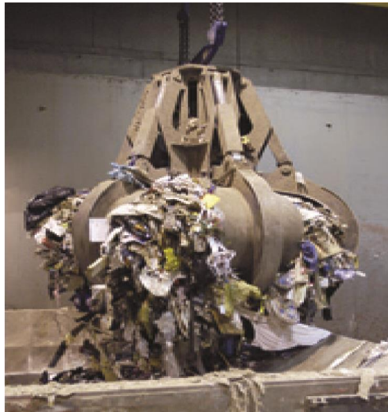
Slika 8. Predodžba kрана za premještanje otpada.[10]
