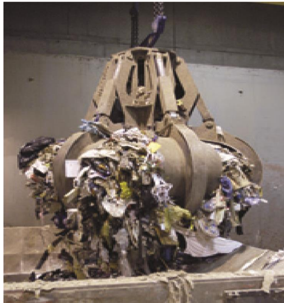
Slika 8. Predodžba kрана za premještanje otpada. [10]
