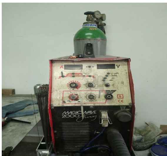
Slika 30. TIG aparat Fronius magic wave 2000
