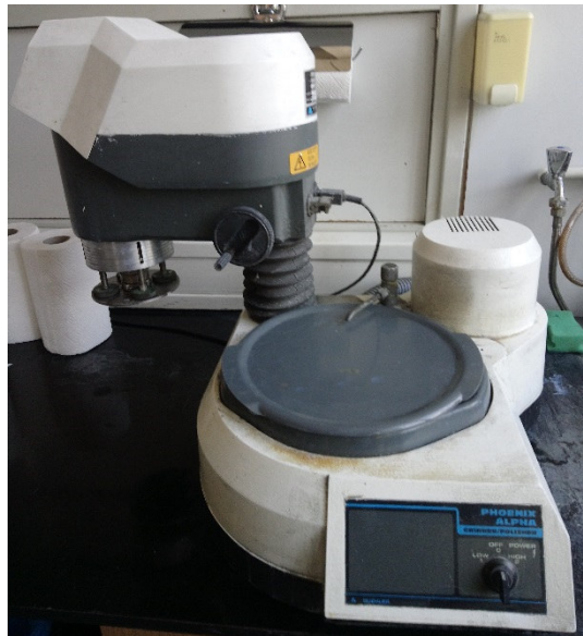
Slika 34. Aparat za brušenje i poliranje Buehler Gridrer/Polisher
