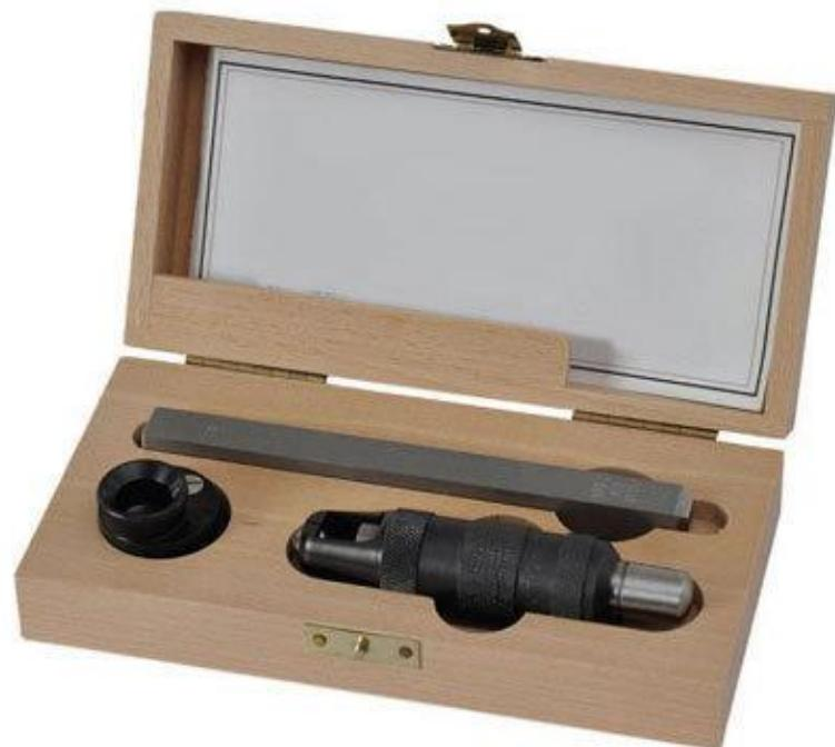
Slika 9 Ispitivanje tvrdoće po Poldiju [21]
