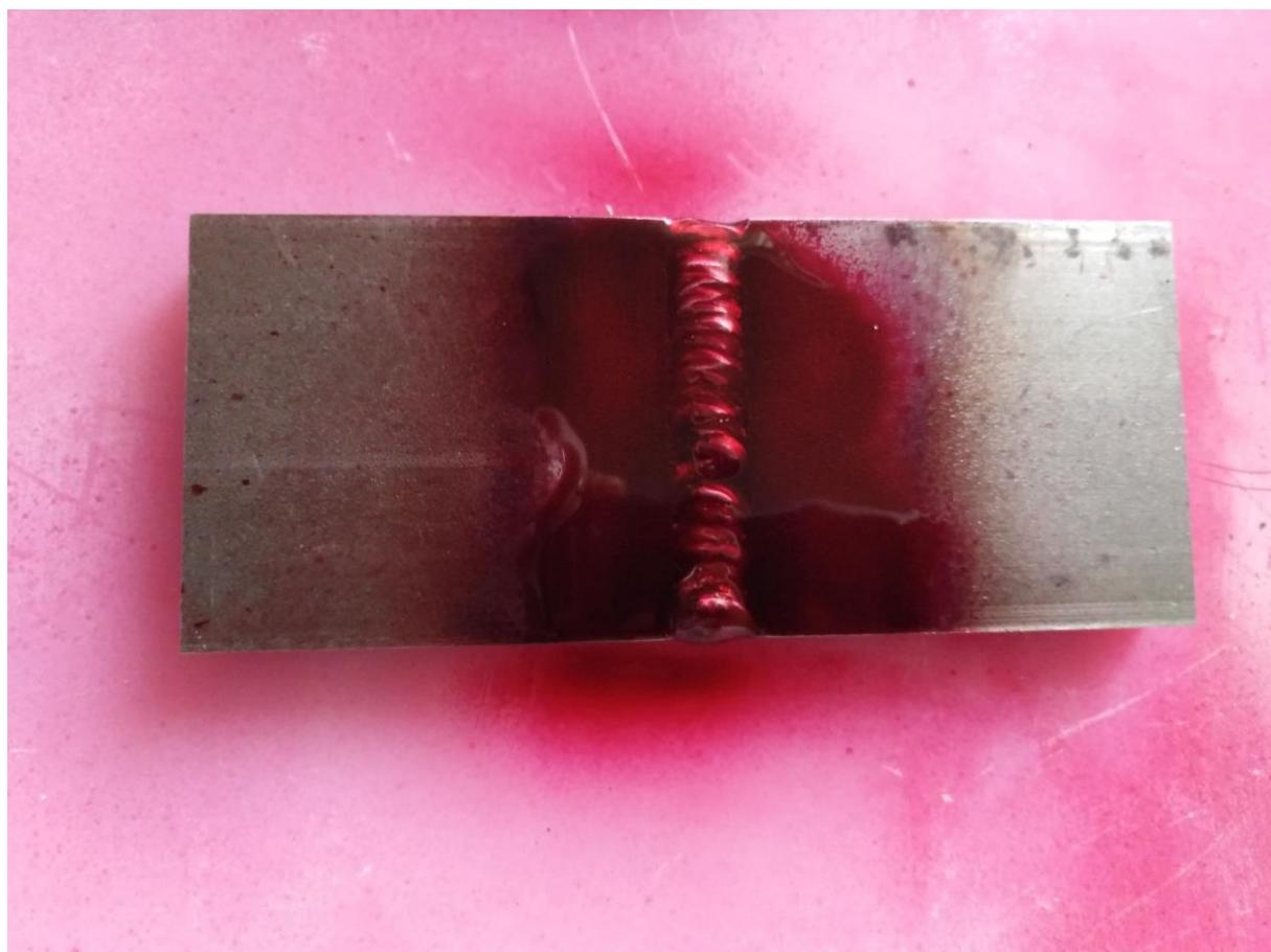
Slika 37 Nanošenje penetranta na površinu zavara ispitnog objekta 1
