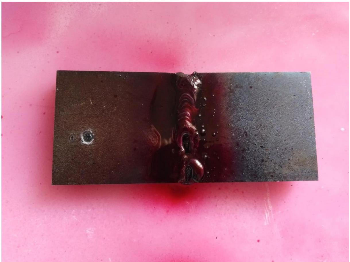
Slika 38 Nanošenje penetranta na površinu zavara ispitnog objekta 2
