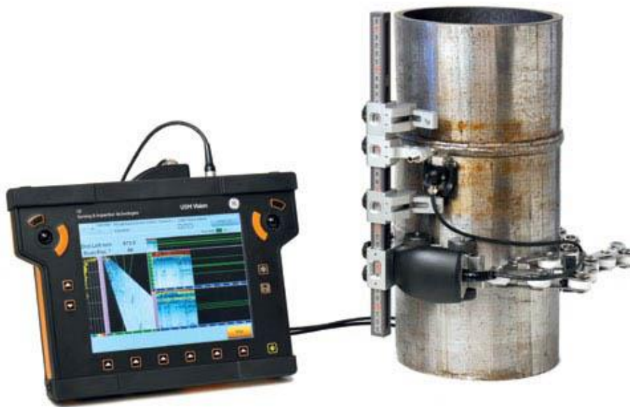
Slika 23 Ultrazvučno ispitivanje zavora [22]
