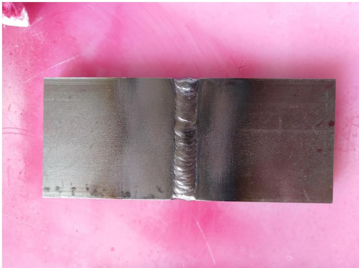
Slika 35 Očišćeni ispitni objekt 1 spremam za nanošenje penetranta
