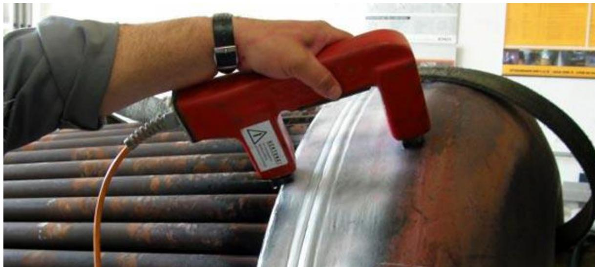
Slika 1.Ispitivanje nerazornom metodom [12]
