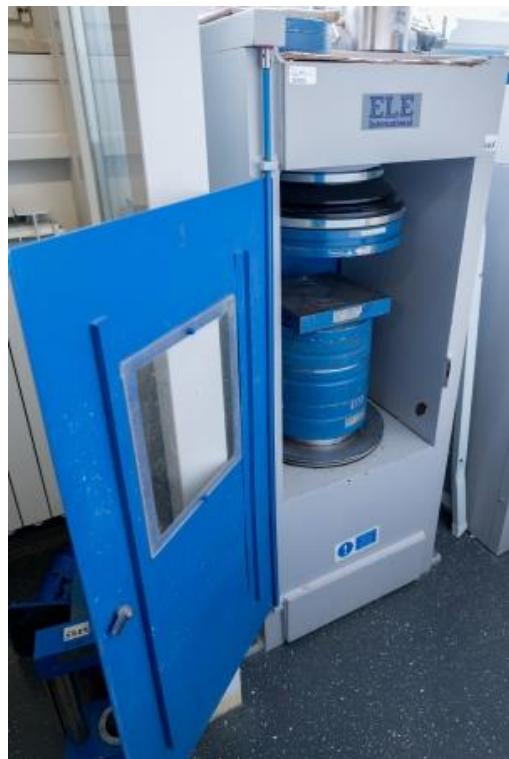
Slika 13 Tlačna preša [17]
