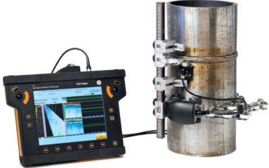
Slika 23 Ultrazvučno ispitivanje zavara [22]
