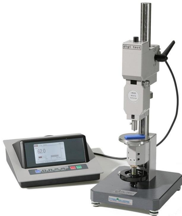
Slika 8 Ispitivanje tvrdoće po Shoreu [20]
