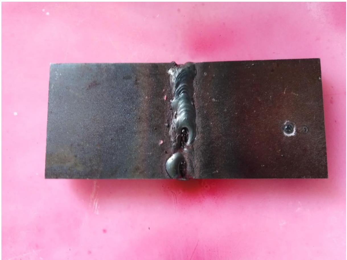
Slika 36 Očišćeni ispitni objekt 2 spreman za nanošenje penetranta
