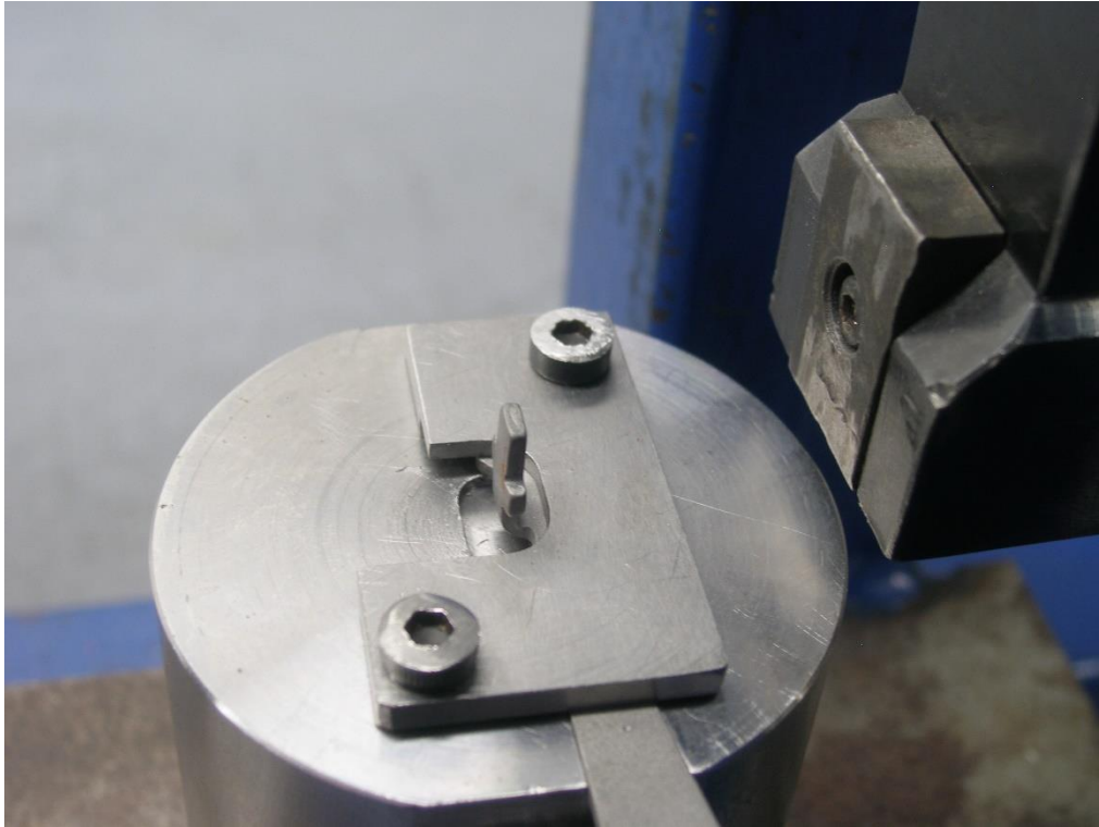
Slika 49: Ispitni uzorak stegnut u pripremi i bat
