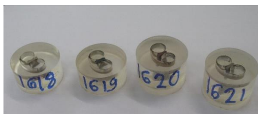
Slika 56: Uzorci pripremljeni za metalografsku analizu
