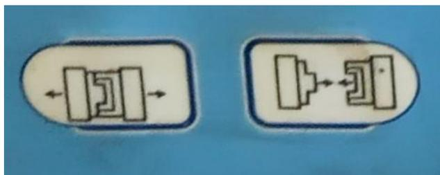
Slika 44. Tipke za upravljanjem otvaranja i zatvaranja kalupa
