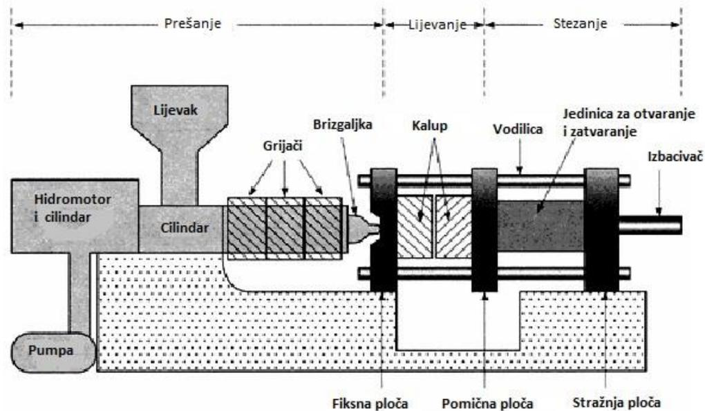
Slika 10. Pojednostavljena shema stroja za injekcijsko prešanje [3]
