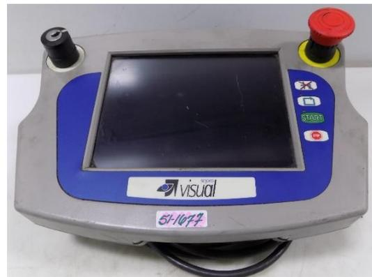
Slika 9. Kontroler za upravljanje sa Sepro robotom
