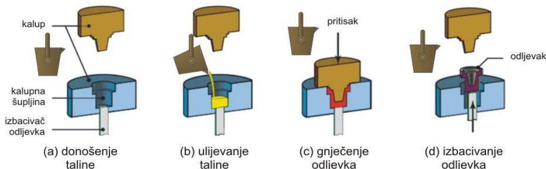
Slika 4. Postupak lijevanja [11]
