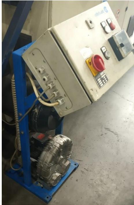
Slika 41. Pumpa za dovod materijala Colotronic
