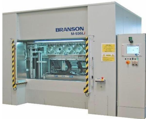
Slika 30. Uređaj za montažu (vibraciono zavarivanje) [12]
