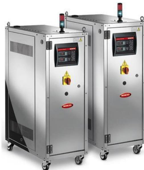
Slika 13. Uređaj za temperiranje kalupa (temperiralo) [5]
