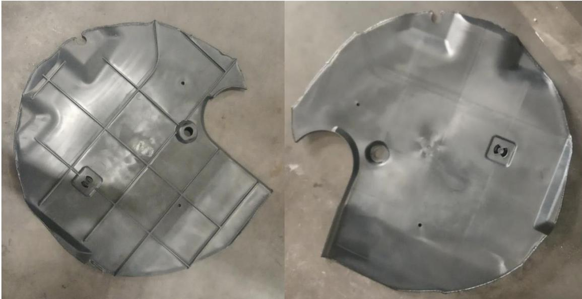
Slika 50. Dio proizvoda dobiven ubrizgavanjem sa sapnicom broj 3
