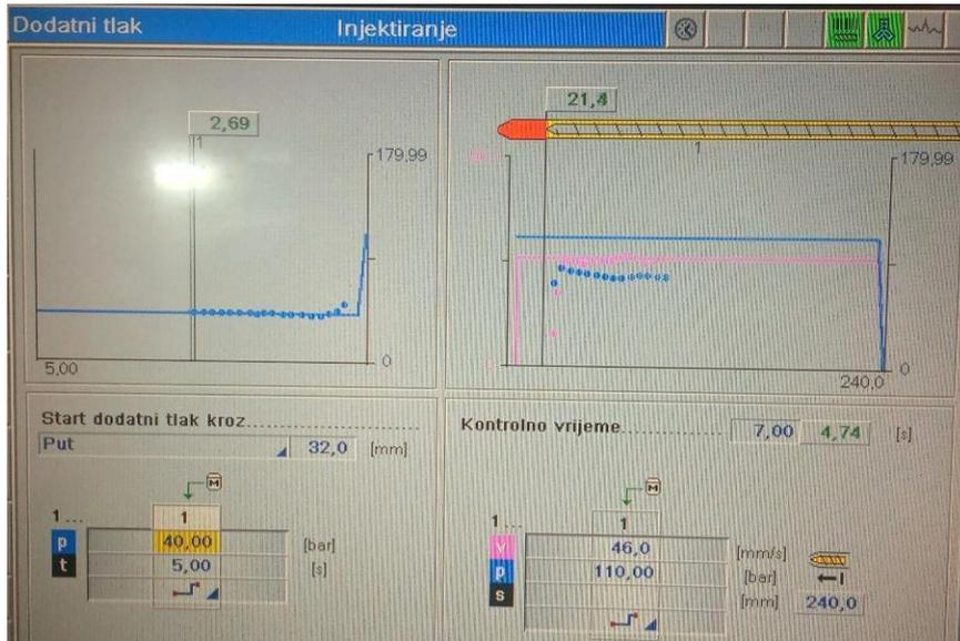
Slika 55. Parametri injektiranja 3
