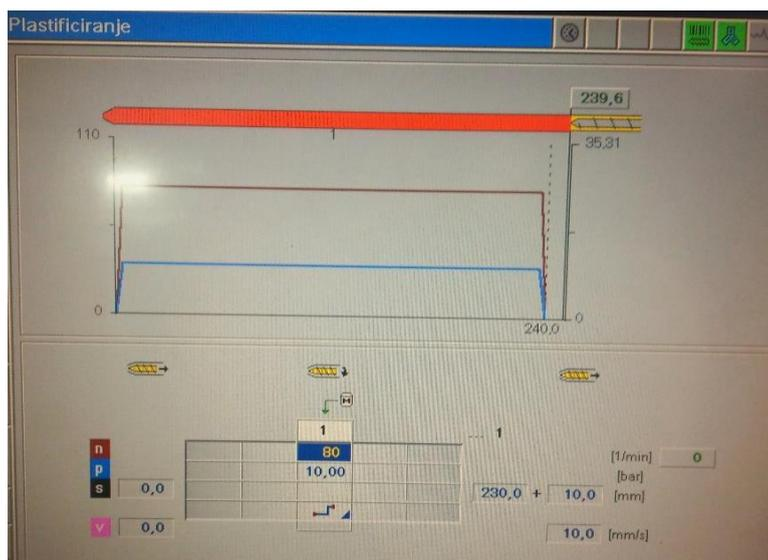
Slika 47. Parametri plastificiranja
