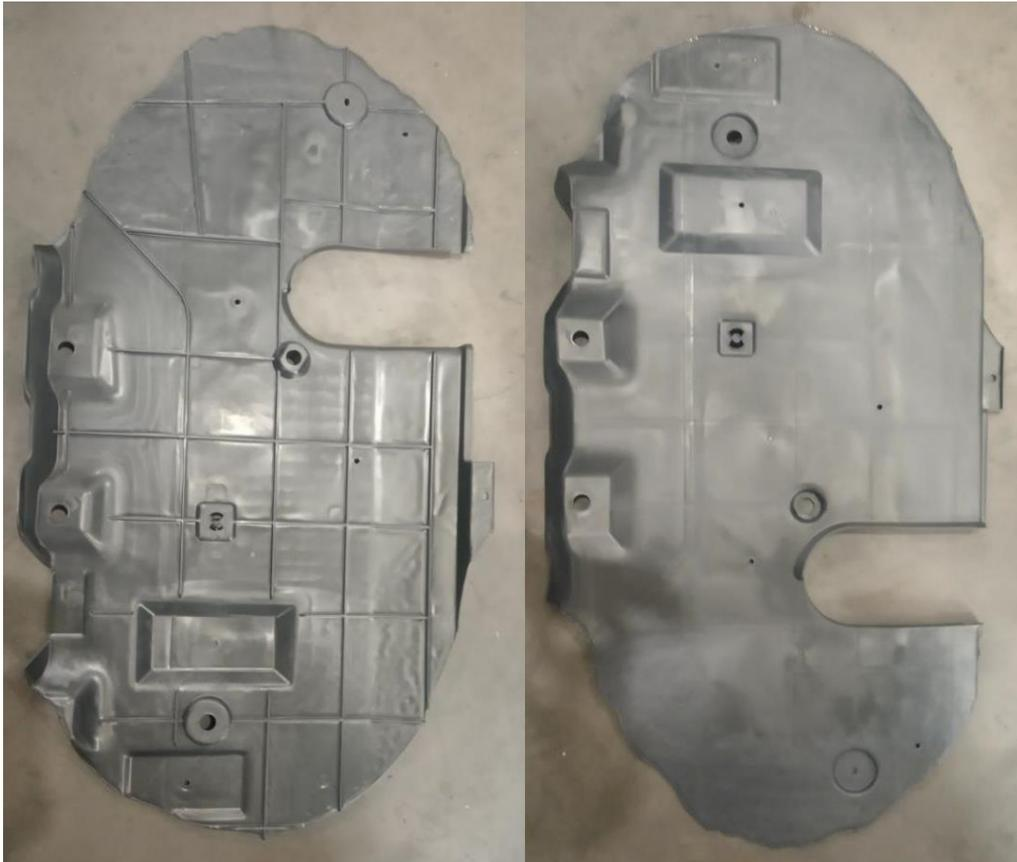
Slika 53. Dio proizvoda dobiven ubrizgavanjem sa sapnicama 2,3 i 4
