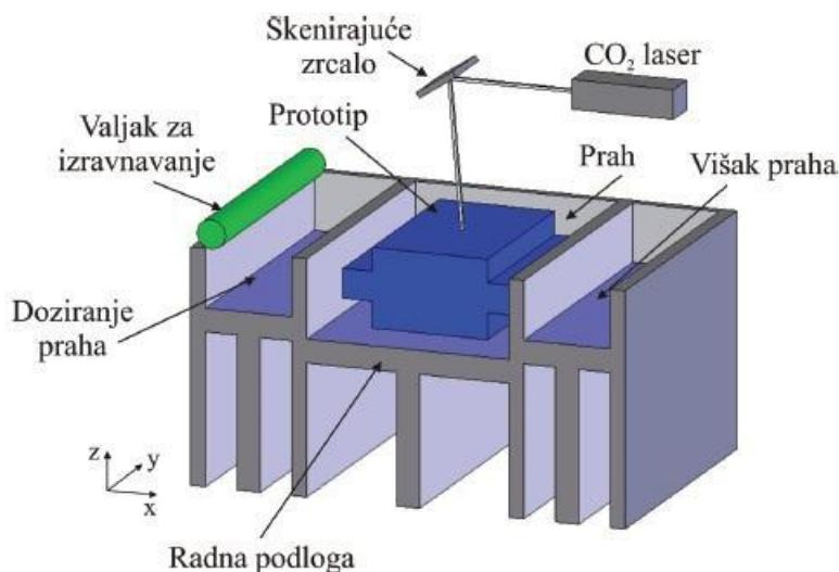
Slika 13. Postupak Selektivnog laserskog sraščivanja. [6]
