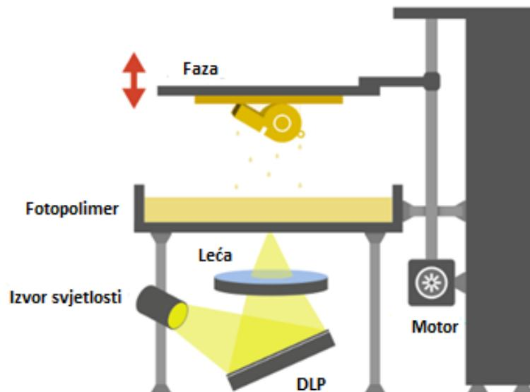
Slika 10. Princip rada DLP postupka. [12]
