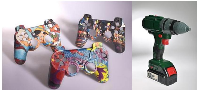
Slika 5. Primjeri proizvoda nastalih LOM postupkom. [8]
