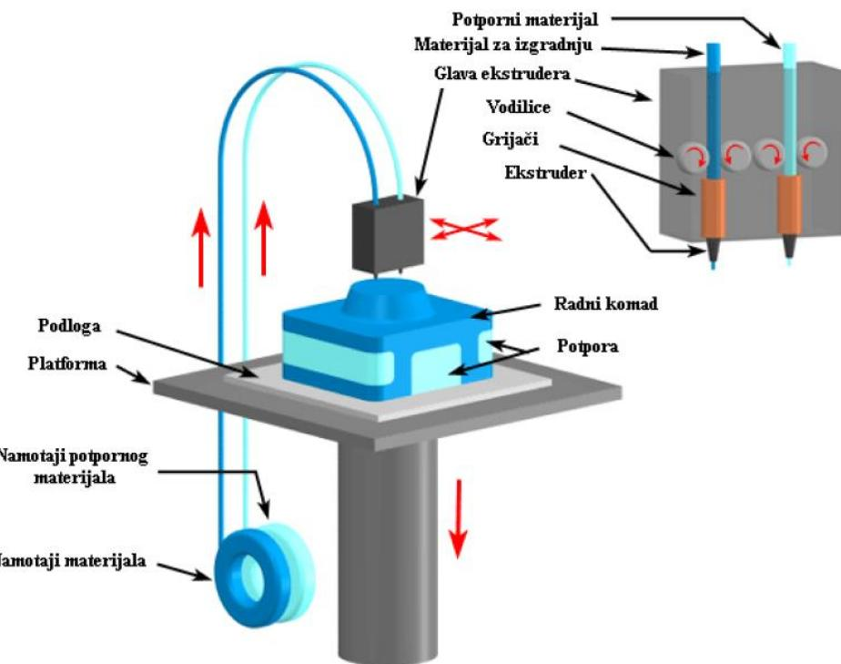
Slika 19. Princip rada Taložnog očvršćivanja. [20]
