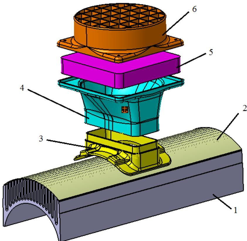
Slika 28. Prototip rashladnog sustava protočnog UV sterilizatora vode.
