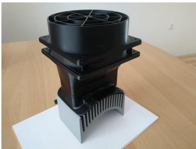
Slika 41. Rashladni sustav protočnog UV sterilizatora vode.
