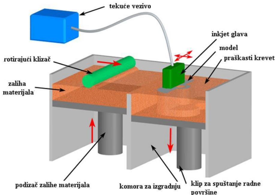
Slika 16. Princip rada 3D print postupka. [17]
