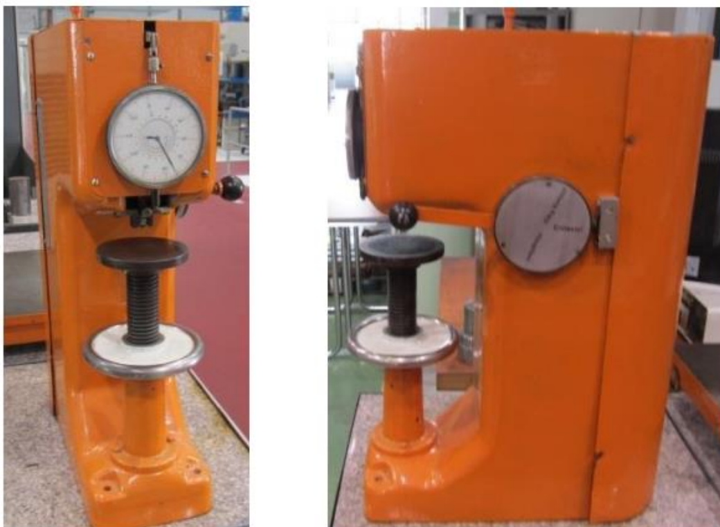
Slika 40 Stroj za ispitivanje tvrdoće HBW 2,5/187,5 [18]
