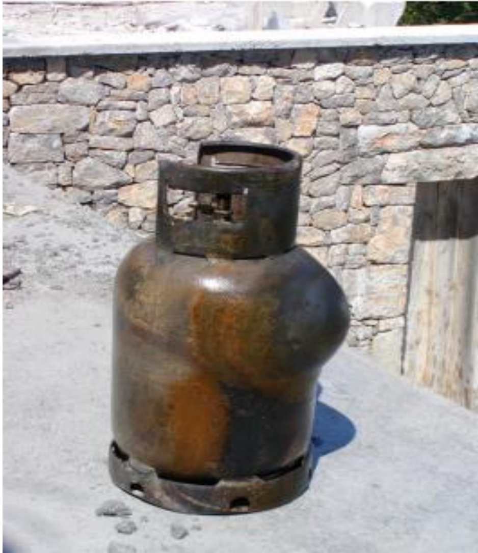
Slika 21. Deformacija plinske boce zbog zagrijavanja.[30]
