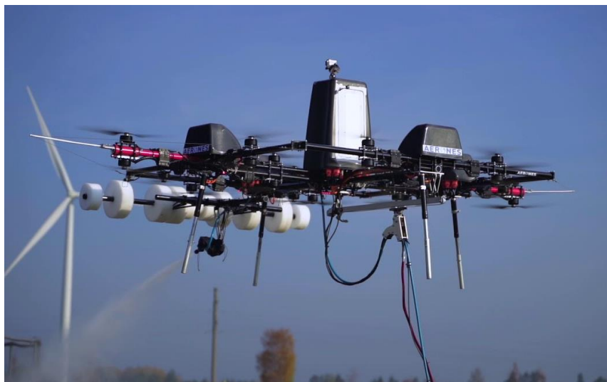
Slika 5. Dron s mlaznicom tvrtke Aeronex.[6]
