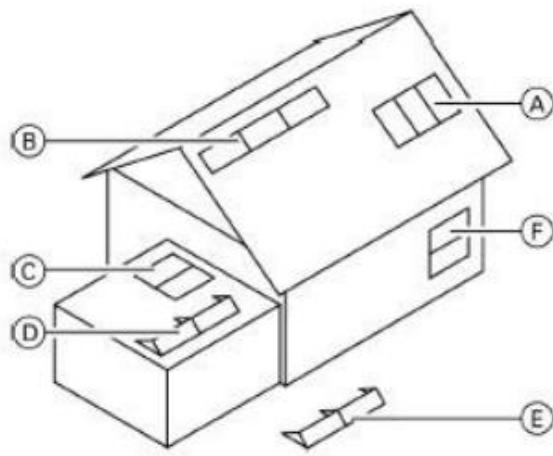
Slika 3.8. Moguće izvedbe postavljanja solarnih kolektora [2]
