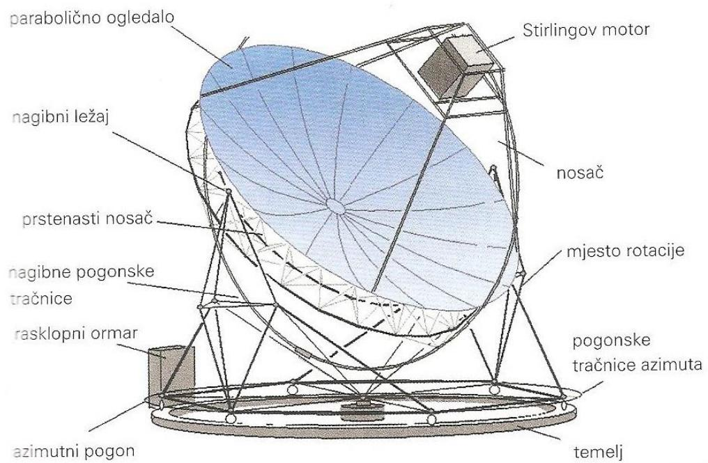
Slika 8.1. Sastavni dijelovi paraboličnog Stirlingova sustava [1]
