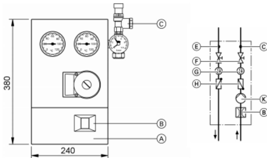
Slika 6.3. Solarna crpna stanica sa sigurnosno tehničkom opremom [1]
