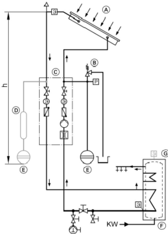
Slika 6.1. Shema solarnog sustava sa sigurnosno-tehničkom opremom [1]
