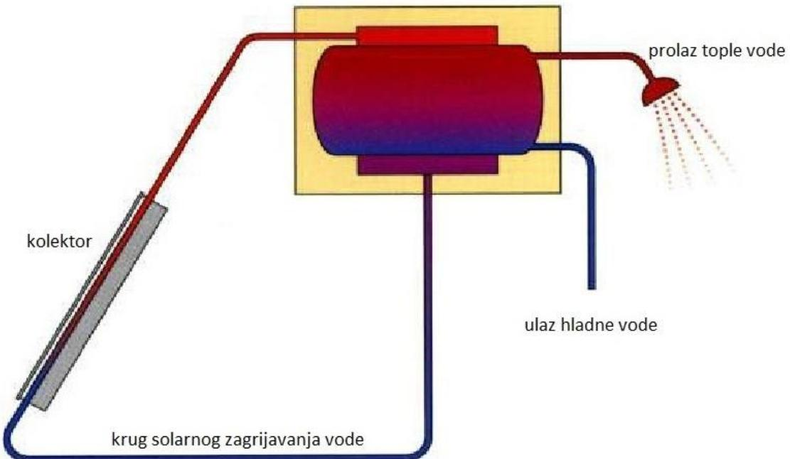
Slika 5.1. Termosifonski solarni sustav s horizontalnim spremnikom [1]
