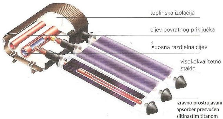
Slika 3.5. Priključno kućište vakuumskoga cijevnog kolektora [1]
