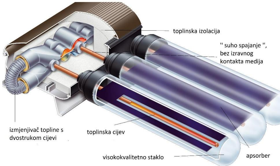
Slika 3.7. Priključno kućište vakuumskih kolektora s toplinskim cijevima [1]
