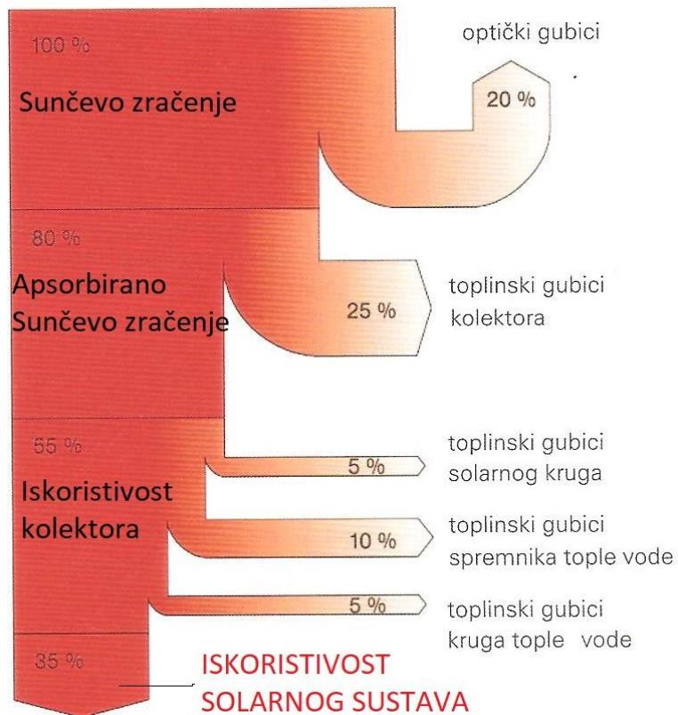
Slika 2.1. Iskorištenje Sunčeva zračenja kod solarnog sustava [1]
