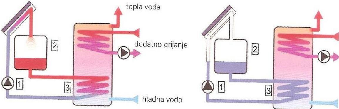
Slika 5.3. Načelo rada solarnog sustava s ispuštanjem i povratom tekućine [1]
