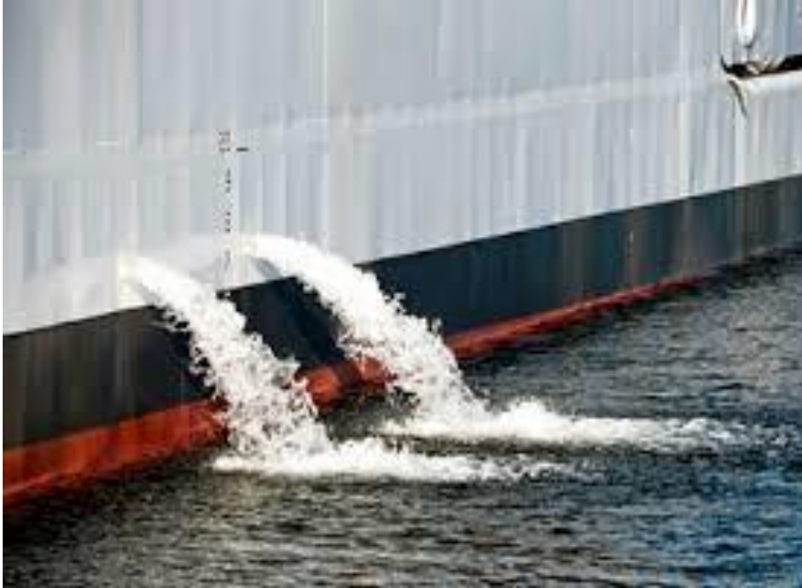
Slika 2. Ispuštanje balastnih voda
