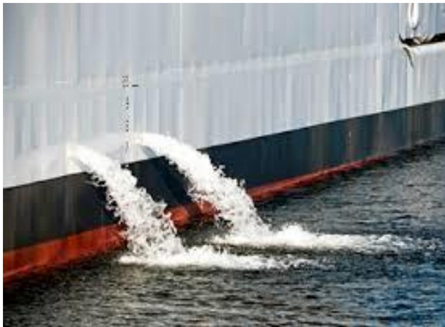
Slika 2. Ispuštanje balastnih voda
