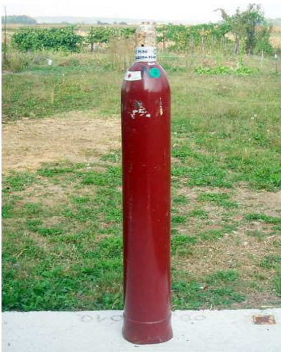
Slika 19. Izgled boce punjene acetilenom.
