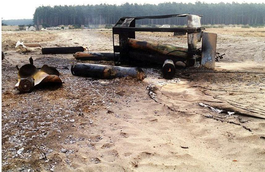
Slika 25. Izgled opožarenog područja nakon eksplozija boca s acetilenom
