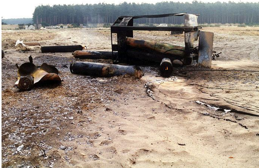
Slika 25. Izgled opožarenog područja nakon eksplozija boca s acilenom
