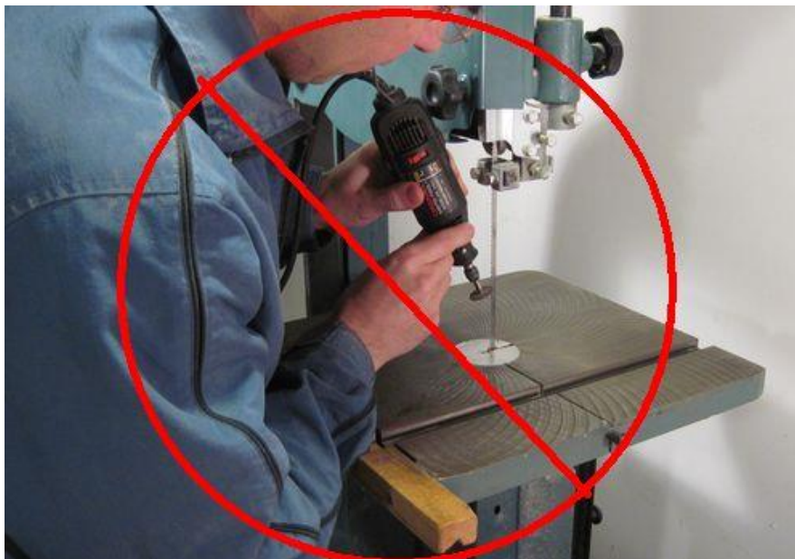
Slika 9. Nepravilno oštrenje zupca tračne pile [9]
