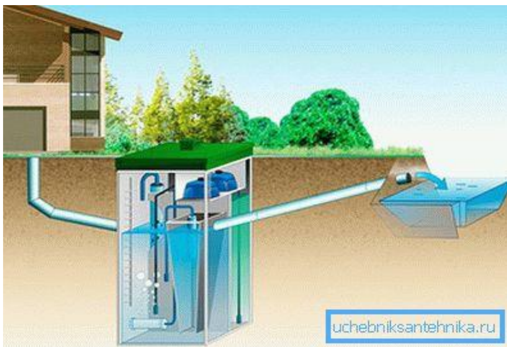
Slika 15. Septonski spremnik za visoke razine podzemnih voda
